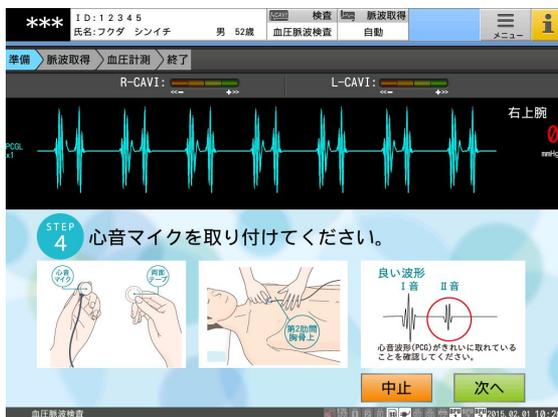
**Способ установки микрофона для звука сердечного клапана**
