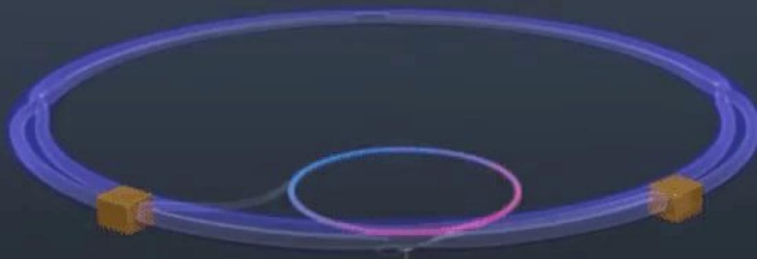
Трубы имеют четыре пересечения, в которых установлены детекторы. Они регистрируют продукты столкновения частиц. В это время баки продолжают добавлять энергию протонам. Направляющие магниты изменяют траекторию протонов и переводят на встречный курс.
