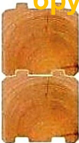
Профиль с двумя шипами
