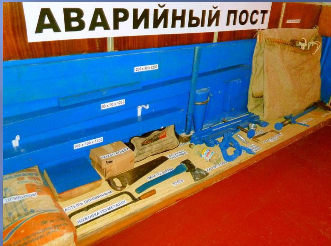
Пластыри, струбцины, столярный инструмент, такелажный инструмент и судовые дельные вещи, цемент, жидкое стекло и т.д.
