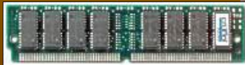
SIMM. Модуль памяти с однорядным расположением микросхем
