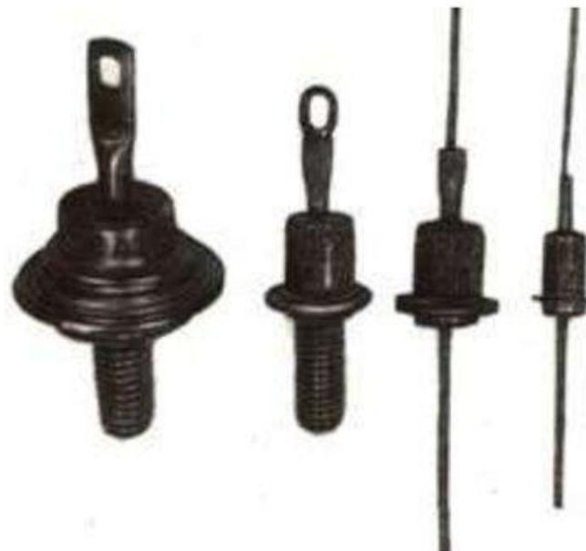
Постоянный электрический ток можно получить при включении диода в цепь с переменным напряжением
