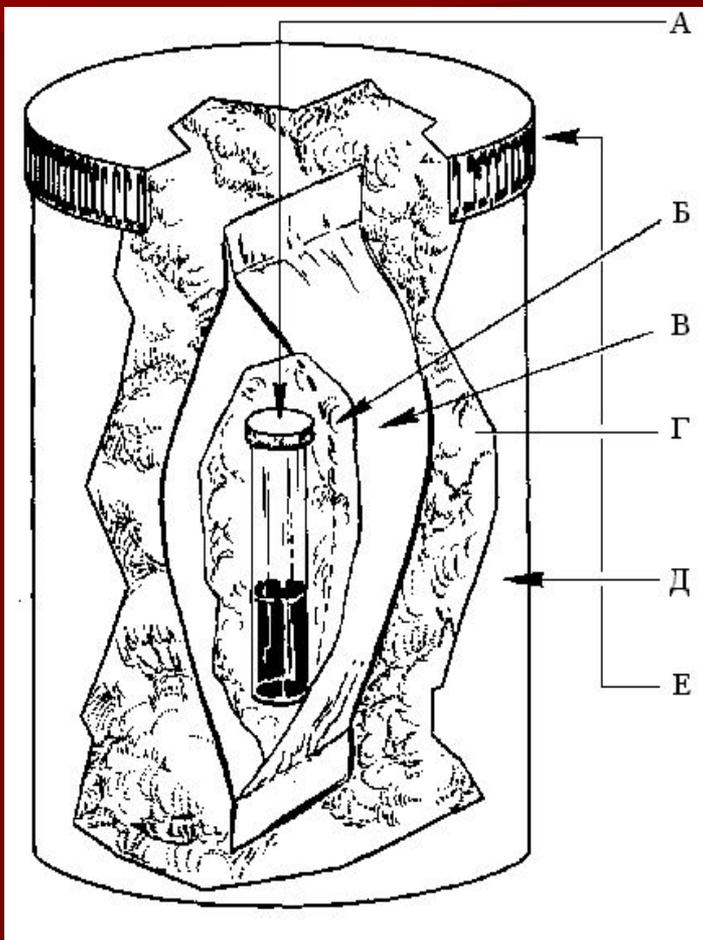
А – стакан, содержащий образец: запаянная стеклянная ампула или наглухо закупоренный флакон с завинчивающейся крышкой, имеющий прокладку из нетоксичной резины;
