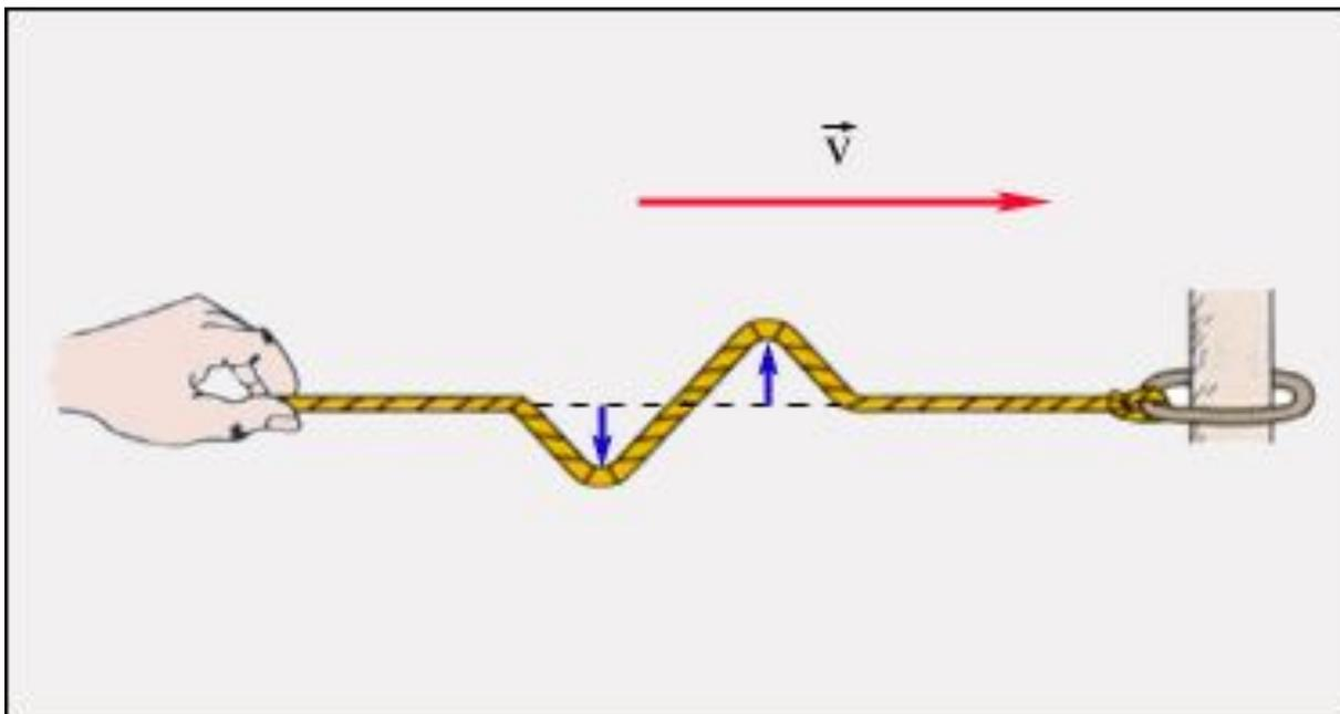
Распространение поперечного волнового импульса по натянутому резиновому жгуту.
