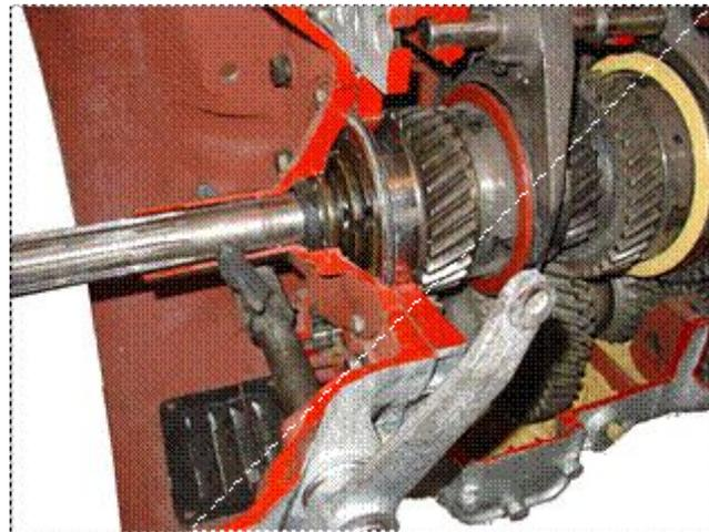
Переключение передач в делителе увеличивает вдвое число передач, позволяет получить передаточные числа, близкие к среднему значению двух соседних передач основной пятиступенчатой коробки передач, и изменяет скорость и величину тяги автомобиля приблизительно в 1,22 раза.
