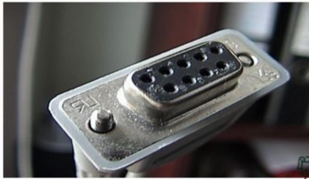
**Асинхронный последовательный интерфейс** — это основной тип интерфейса, с помощью которого осуществляется взаимодействие между компьютерами. Термин «асинхронный» означает, что при передаче данных не используются никакие синхронизирующие сигналы и отдельные символы могут передаваться с произвольными интервалами, как, например, при вводе данных с клавиатуры.
