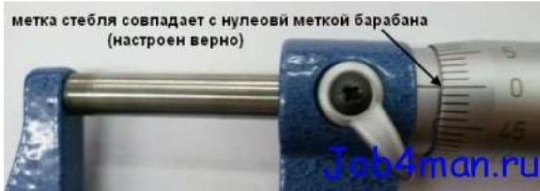
Рис.4. Установка микрометра на нуль
