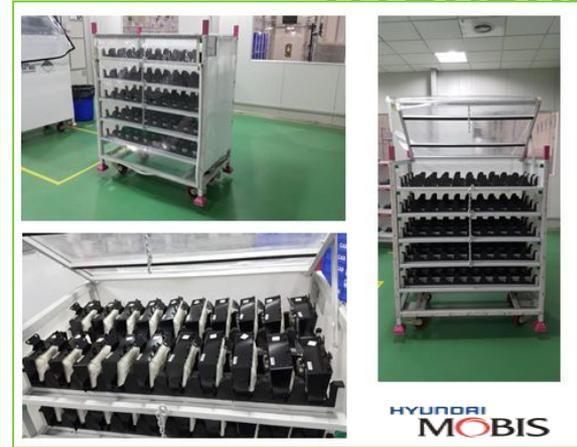
Для ХММР нами были изготовлены стеллажи для хранения кузовных деталей, а именно стеллажи для дверей, капотов, багажников, стёкол. А также тележки для транспортировки различного рода автокомплектующих по территории завода и между поставщиками с Парка поставщиков. Также изготовлены и модернизированы телеги для поставщиков ХММР
