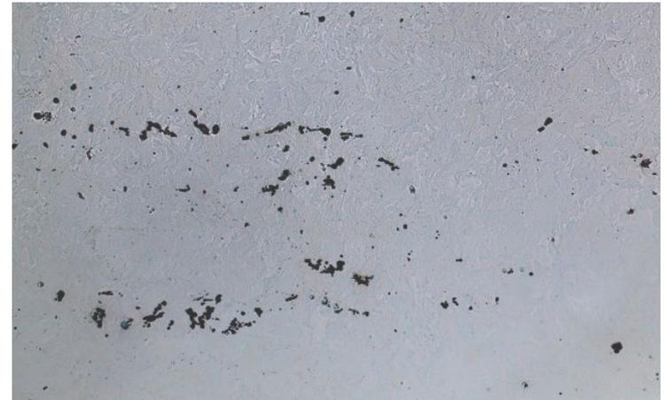
Фотографии микроструктуры металла двух крепёжных изделий, изготовленных из низкоуглеродистой стали: а - партия 1 – содержание элементов-раскислителей (Mn, Si) в норме; б – партия 2 – содержание элементов-раскислителей значительно ниже нормы
