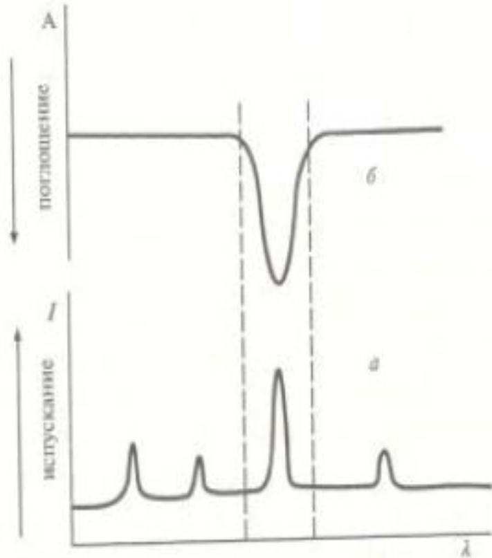
Спектры: а - эмиссии источника излучения (лампы с полым катодом); б - поглощения анализируемого образца
