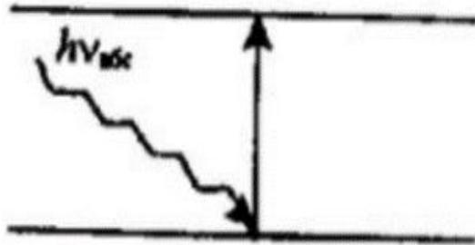
В эмиссионной спектроскопии возникновение аналитического сигнала обусловлено переходом электрона с возбужденного энергетического уровня на нижележащий уровень с испусканием кванта электромагнитного излучения.
