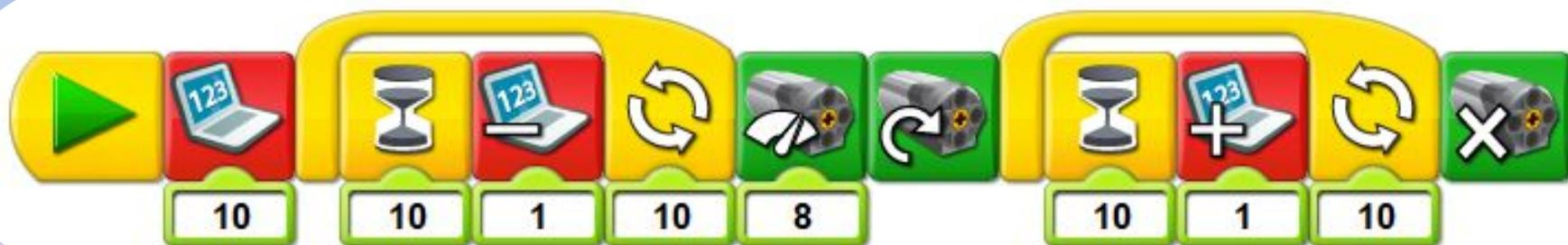
*Данная программа даст обратный отсчет от 10 до 0 и запустит работу механического молотка. Отработав счет от 0 до 10 механический молоток самостоятельно остановится (см. видео 7.)*
