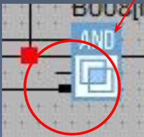
Связи от SA1, SA2 на блок «И» (B007) , от «И»(B007) на (выход Q004) используем для включения светильника EL3, отдельный режим.
