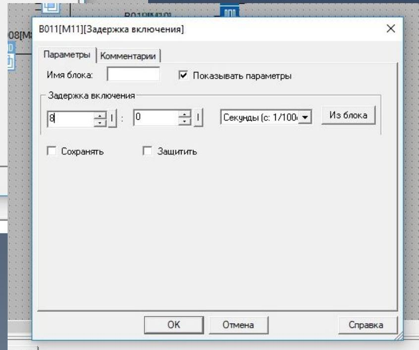
На «Задержке включения» (B010,B011) выставляем таймер согласно Конкурсного задания.
