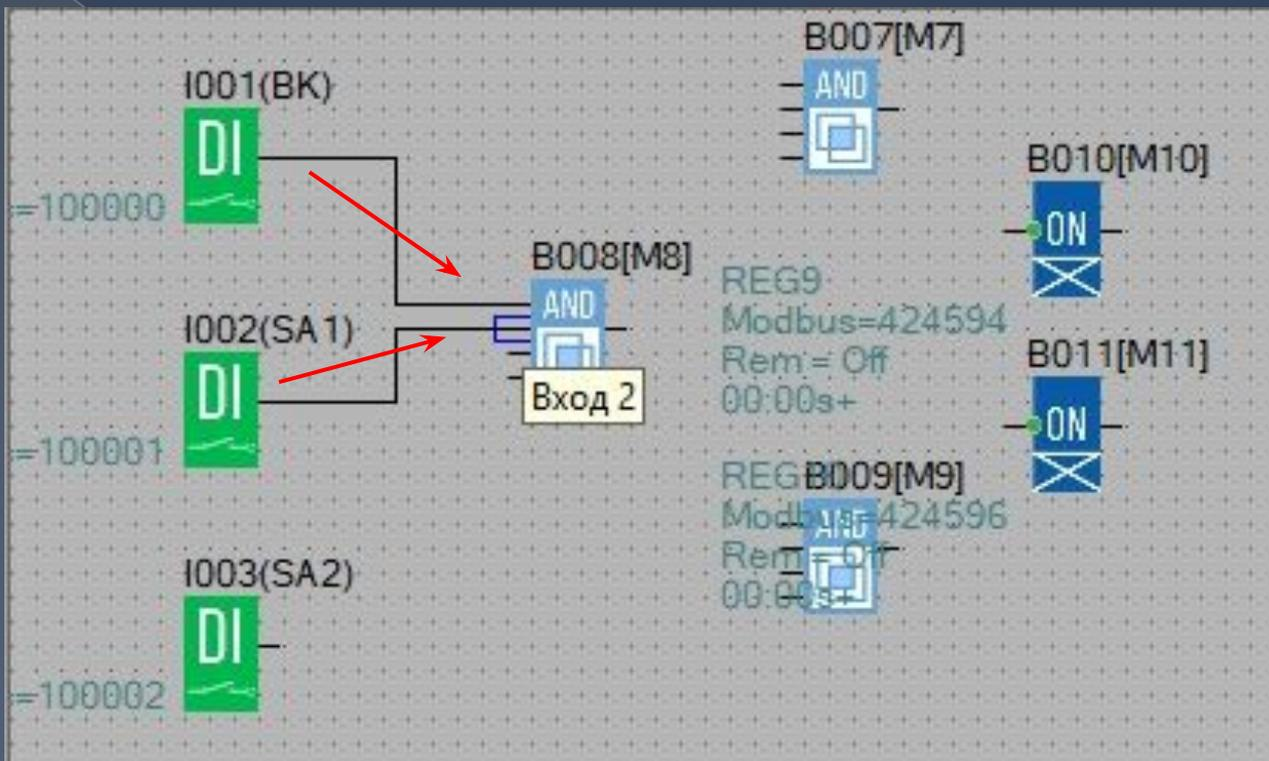
От датчика движения (BK) и выключателя SA1 связь на блок «И». Для выполнения условий К3: поочередное включение светильников EL6,EL7,EL8 в цикле, при поступлении сигнала с BK и включении выключателя SA1.
