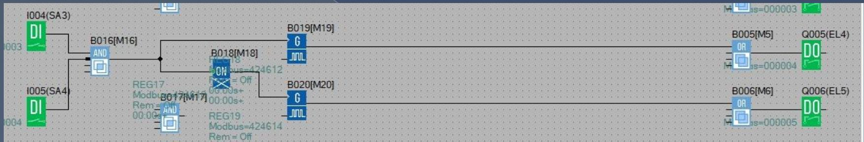
Устанавливаем связи от выхода «И» на «Задержку включ.» и «Генератор импульсов». Выполняя условие: Включаются EL4, EL5 поочередно с периодом 5 сек.
