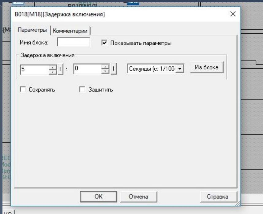
Выставляем таймер задержки включения, задержка пуска «Генератора импульсов» для переключения светильников EL4, EL5.
