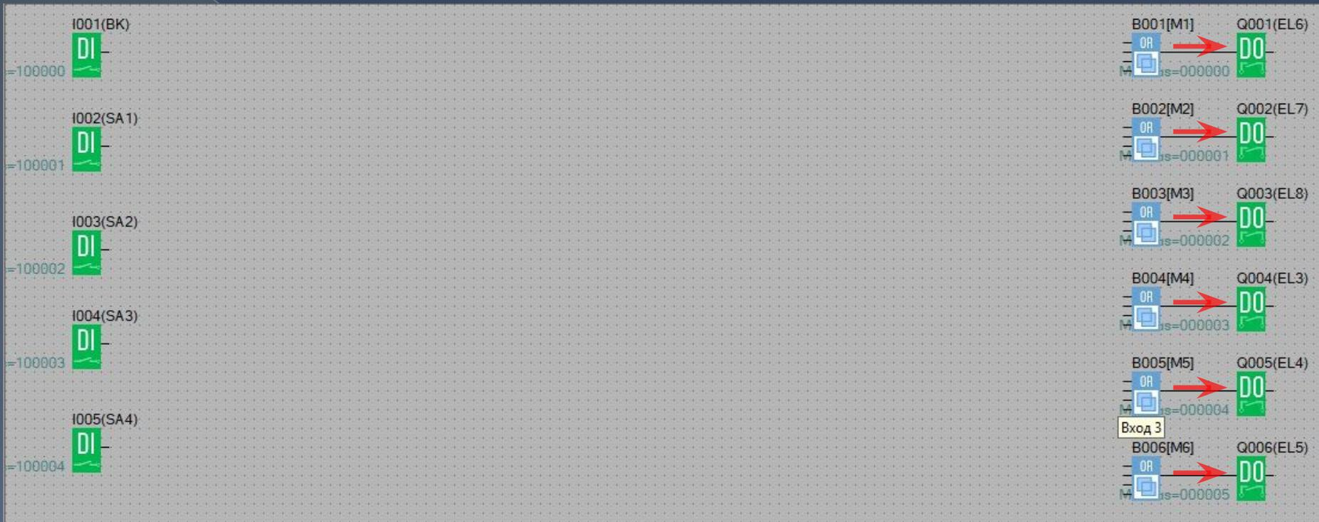
Блок «ИЛИ» устанавливаем на схеме для возможности принятия сигналов от нескольких функциональных блоков.
