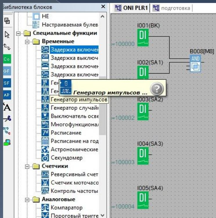
В Библиотеке выбираем блок «Генератор импульсов».
