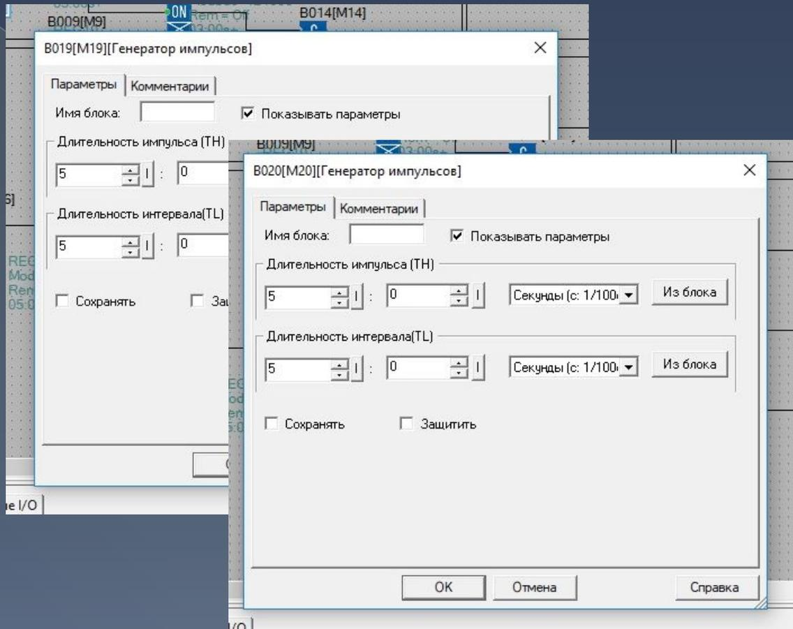
Задаём длительность импульсов включения/отключения светильников EL4, EL5.
