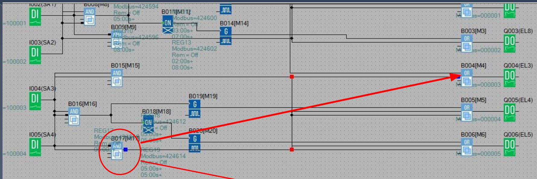
Устанавливаем связи от «SA3» и «SA4» на входы блока «И» (B017), с выхода блока «И» до входа блоков «ИЛИ» (B004, B005, B006).
