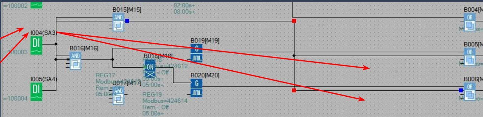
Устанавливаем связи от SA3, SA4 на входы блока «И»(B015), от выхода «И» до входа блоков «ИЛИ» (B005, B006).
