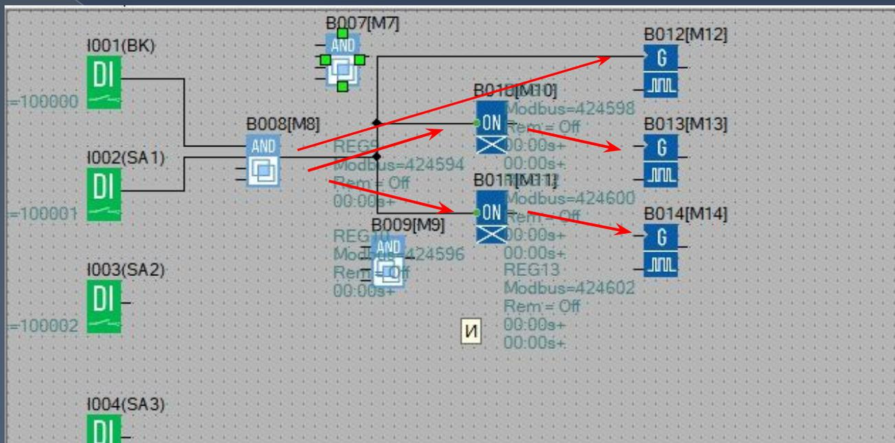
Устанавливаем блоки в схему, и обозначаем связи между блоками «И» до входа на «Генератор» (элемент на схеме B012) на прямую.
