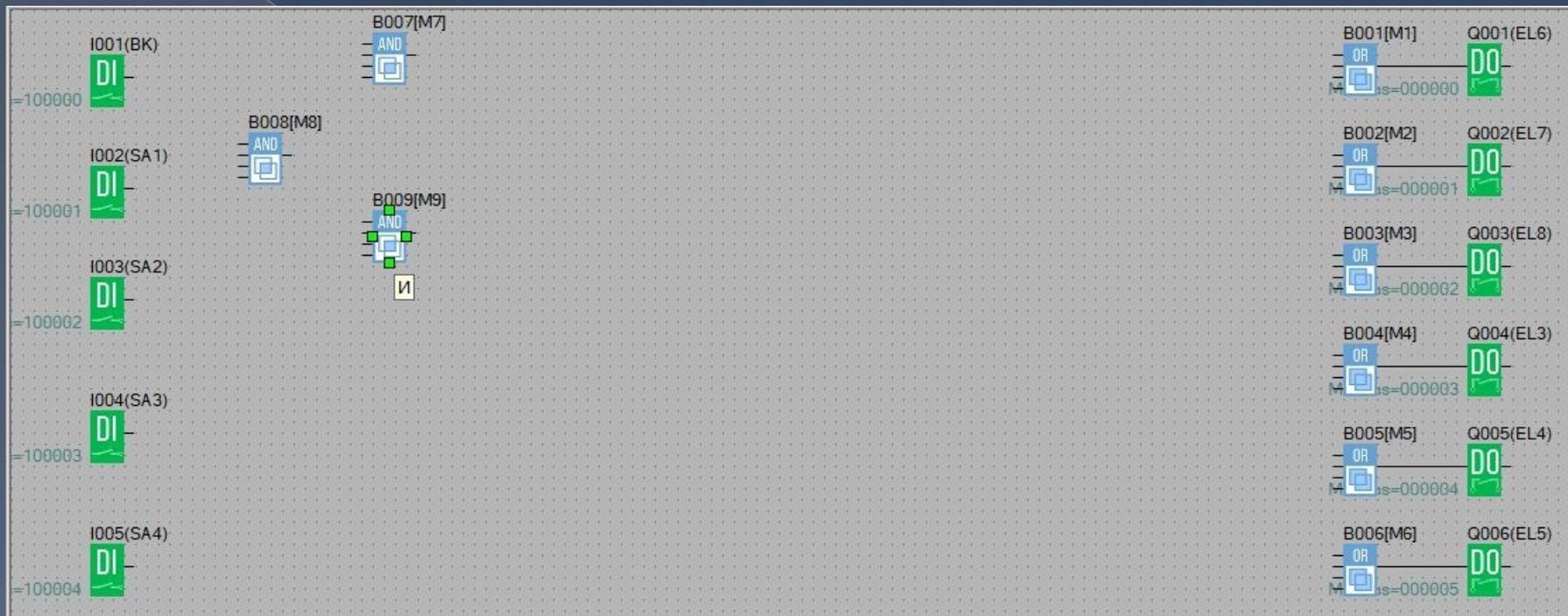
Выбираем и устанавливаем элемент «И». Сигнал будет выходит, в том случае, если на все используемые входы блока приходит сигнал.
