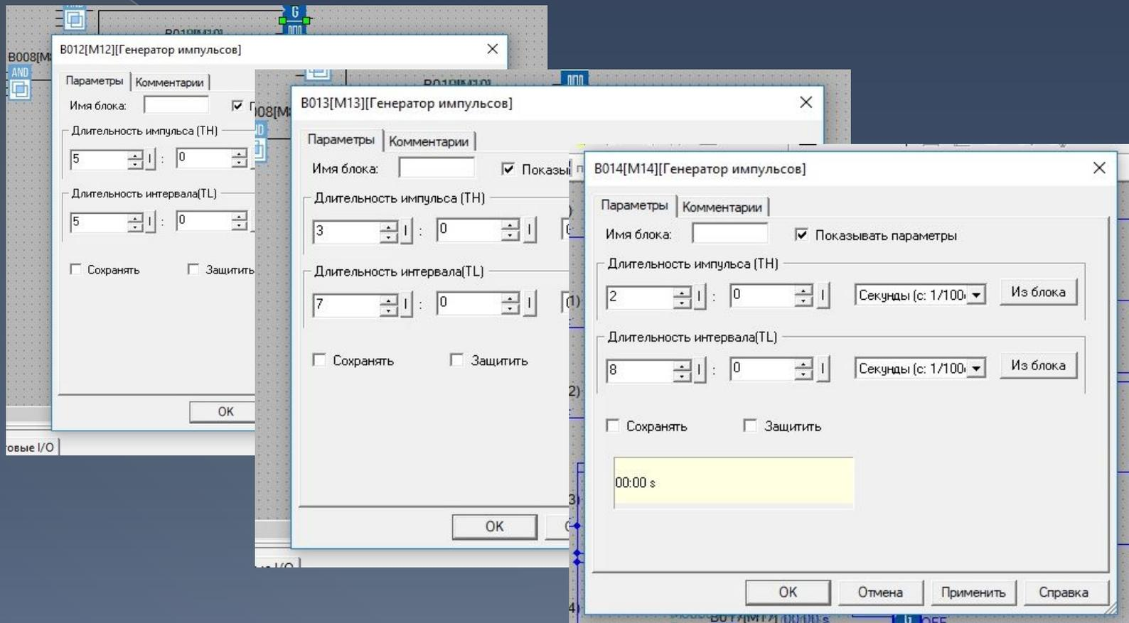
В «Генераторах импульсов» задаём параметры на периодичность включения/отключения светильников, согласно Конкурсного задания.
