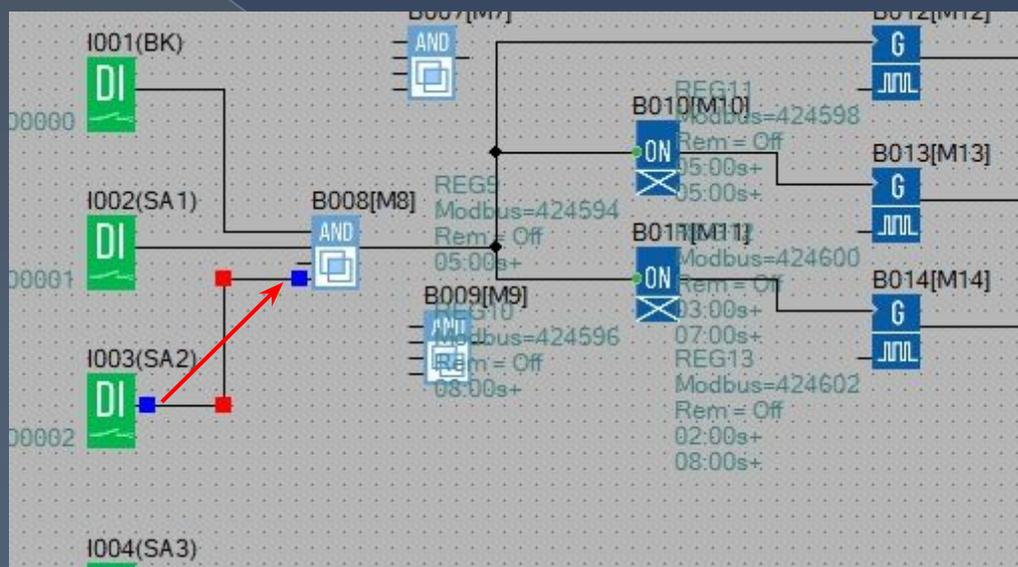
Устанавливаем связь от входа I003(SA2) до блока «И»(B008),
