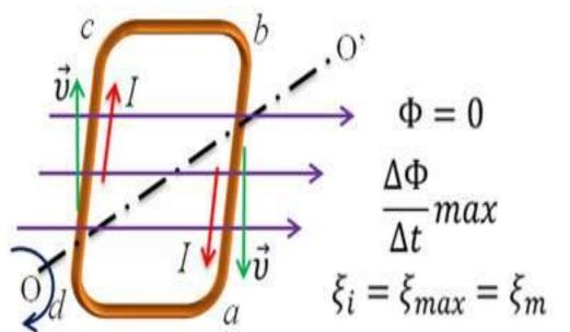
ЭДС, возникшая в этом случае в витке, имеет наибольшее значение. В части *ab* витка, ЭДС будет направлена от чертежа к наблюдателю, а в части cd — от наблюдателя за чертеж.
