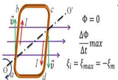
Н**ЯРОТЯВЮ**ПОЛОЖНОЕ: В части ab ЭДС направлена от наблюдателя за чертеж, а в части *bc* — из-за чертежа к наблюдателю. И опять это направление ЭДС сохраниться и при дальнейшем движении витка, при этом абсолютная ее
