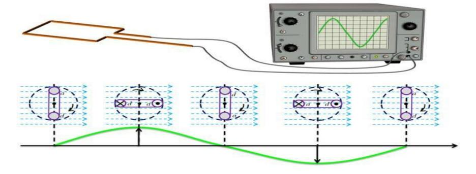
На рисунке изображен график изменения ЭДС индукции в витке за время совершения одного полного оборота. Вверху показаны последовательные положения витка в магнитном поле, против них (внизу) — значения ЭДС индукции в витке. Направление силовых линий магнитного потока, пронизывающего виток, показано стрелками. Кружочки изображают сечение витка плоскостью чертежа с указанием
