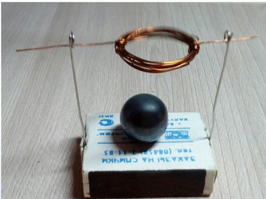
**Назначение:** служит для демонстрации действия магнитного поля на проводник с током.
