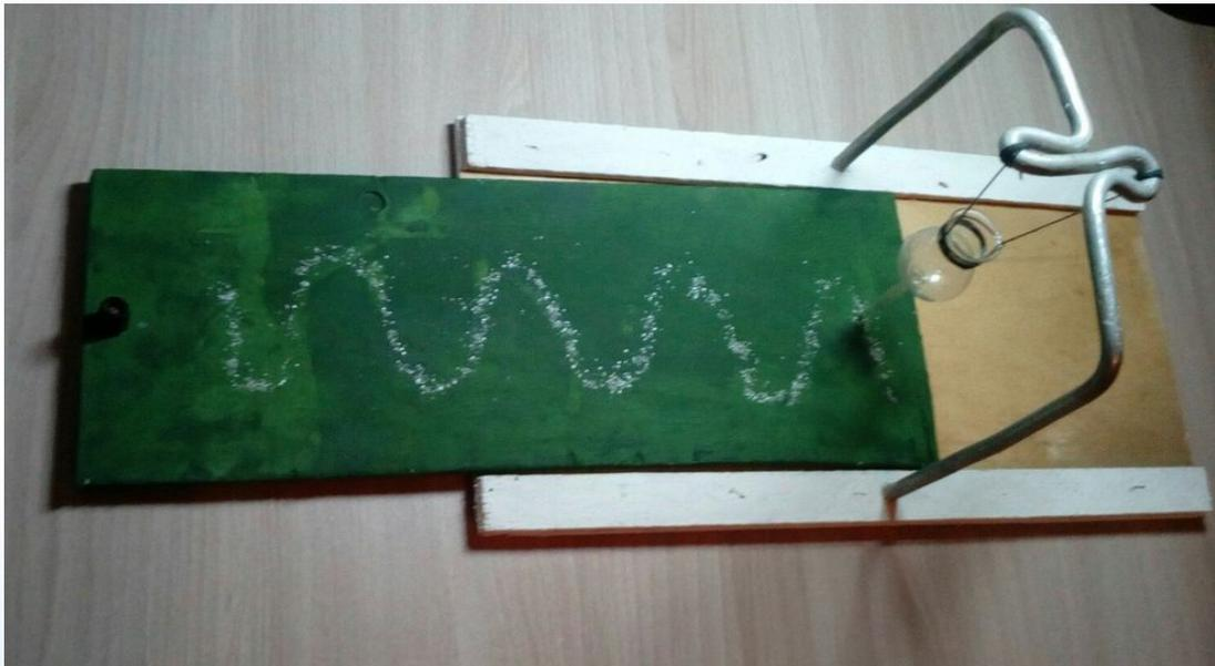
**Назначение:** служит для демонстрации гармонических колебаний и показывающий прямую зависимость координат от времени, представляющую в виде синусоиды.
