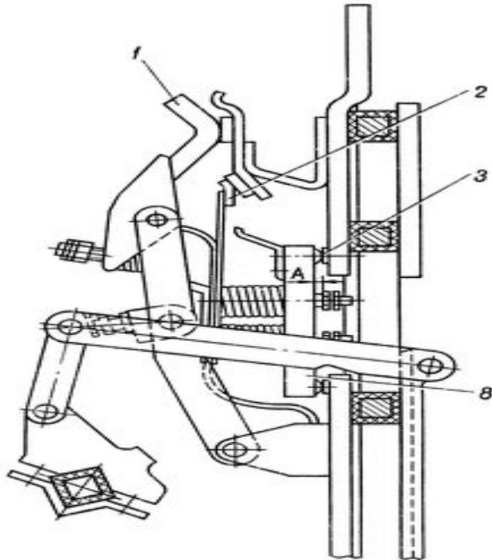
Рисунок 1. Контактная система во включенном положении;
