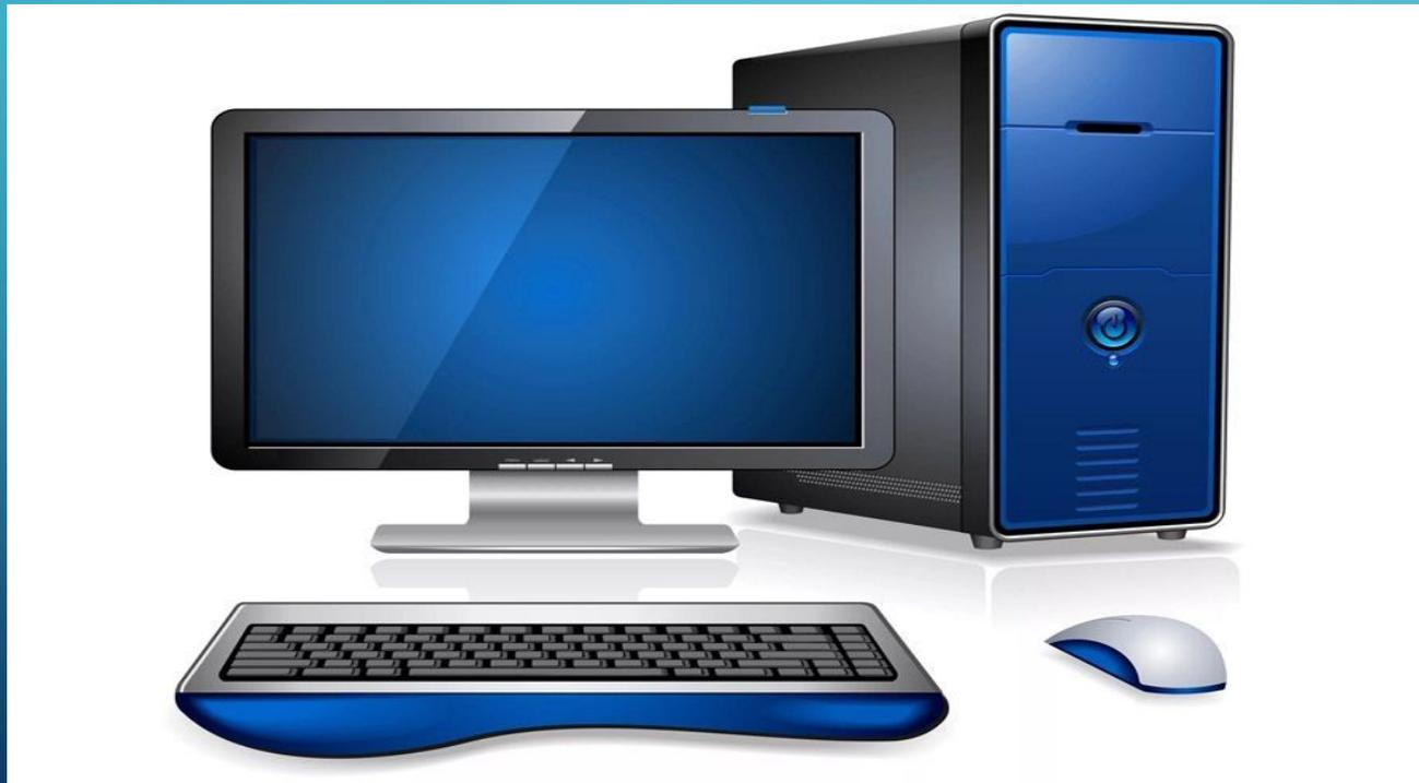
Чтобы «общаться» с человеком, компьютеру необходимы устройства для ввода и вывода информации. В качестве основного устройства ввода сейчас применяется клавиатура с буквенно-цифровыми и управляющими клавишами. Каждая клавиша передает в компьютер уникальный двоичный код, а специальная программа, которая обычно записана в ПЗУ компьютера, преобразует эти коды в вид, приемлемый для использования в программах. Результат работы программы выводится на экран монитора.
