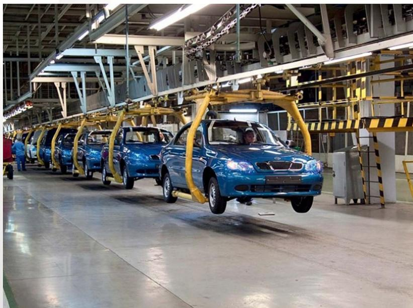
Устройство для непрерывного перемещения обрабатываемого изделия от одного рабочего к другому. Также используется для транспортировки грузов. В 1908 году в США Генри Форд создал успешное поточное производство на основе конвейера, что было знаковым событием для промышленной революции.
