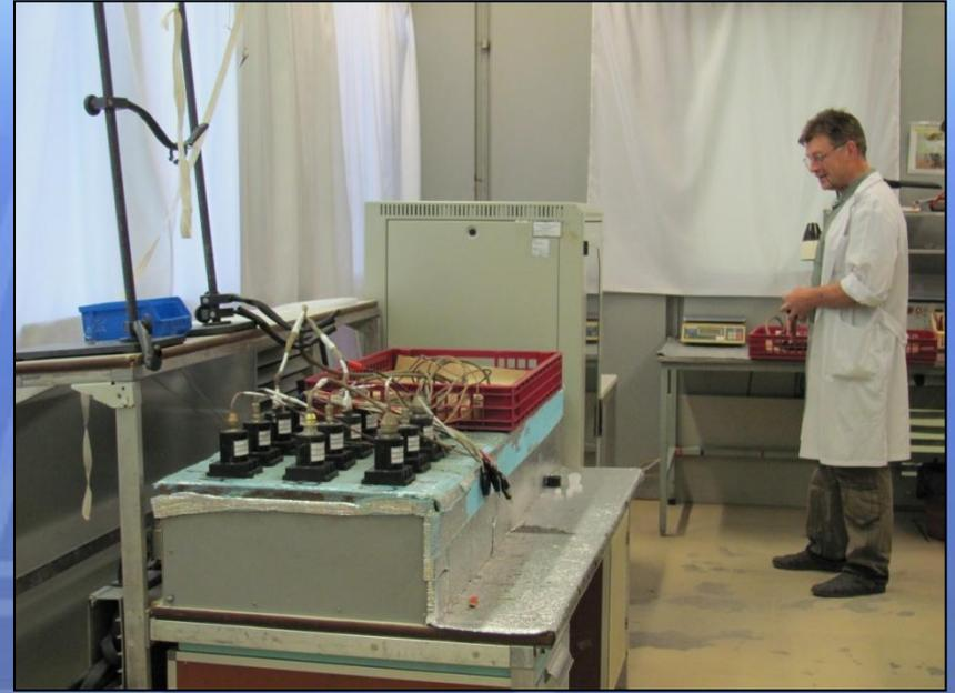
**Установки Лиана Р 100Е обеспечивают автоматический контроль жгутов по следующим параметрам:**
