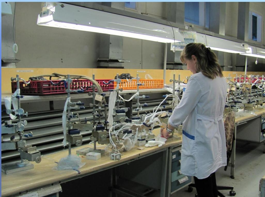
Заливка корпусных и бескорпусных соединителей
