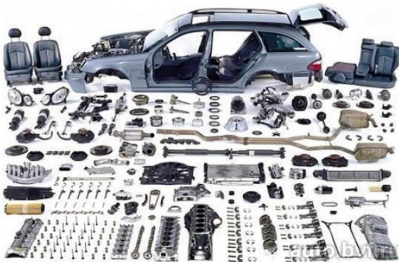
Поточный способ разборки применяется на предприятиях с большой производственной программой ремонта автомобилей одной марки.
