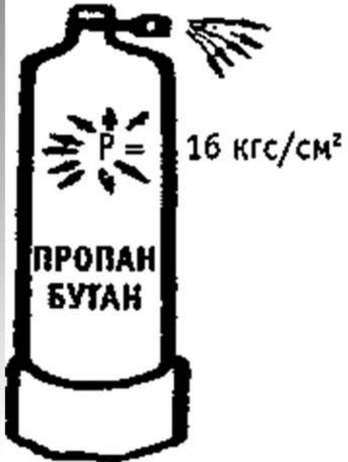
давление в полностью заправленном баллоне с пропан-бутаном при температуре 20°C составляет 1,6 МПа (16 кгс/см<sup>2</sup>); максимальный отбор газа из баллона не должен превышать 0,6 м<sup>3</sup>/ч
