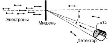
Рис. 1.1. Схема эксперимента по рассеянию релятивистских электронов на атомных ядрах
