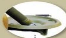
В казенной части ствола установлен стреляюще-предохранительный механизм, позволяющий безопасно разрядить миномет в случае осечки
