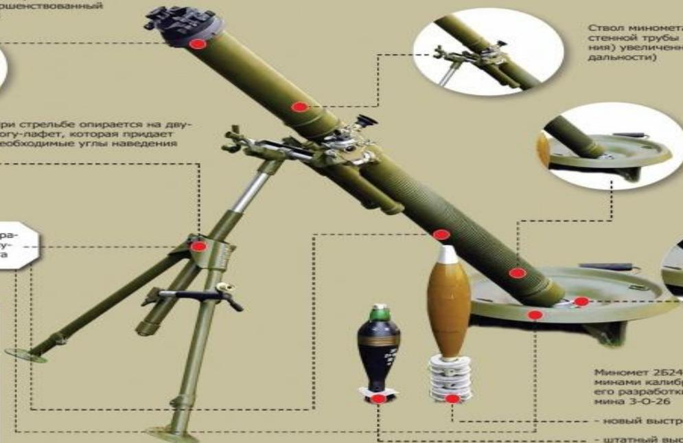
Ствол миномета выполнен в виде гладкоствольной трубы с рифлением (для охлаждения) увеличенной длины (для увеличения дальности)
