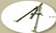
При транспортировке разбирается на три части: ствол, двуногая опора и опорная плита
