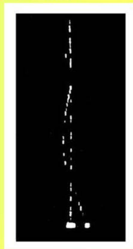
Трек частицы в узкоззорной искровой камере
