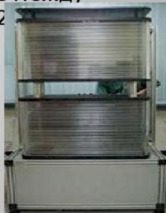
Внешний вид двухсекционной искровой камер
