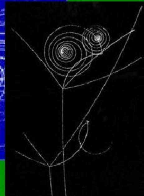
Действие камеры основано на конденсации перенасыщенного пара на ионах с образованием капелек воды
