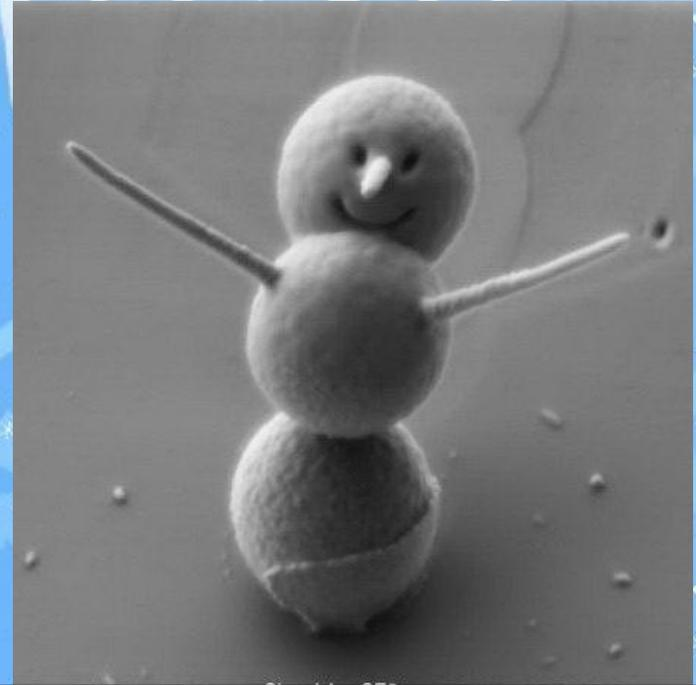
**Снеговик состоит из 3 сфер размером 0,9 микрон каждая, а рожица у него прорезана с помощью электронного пучка.**
