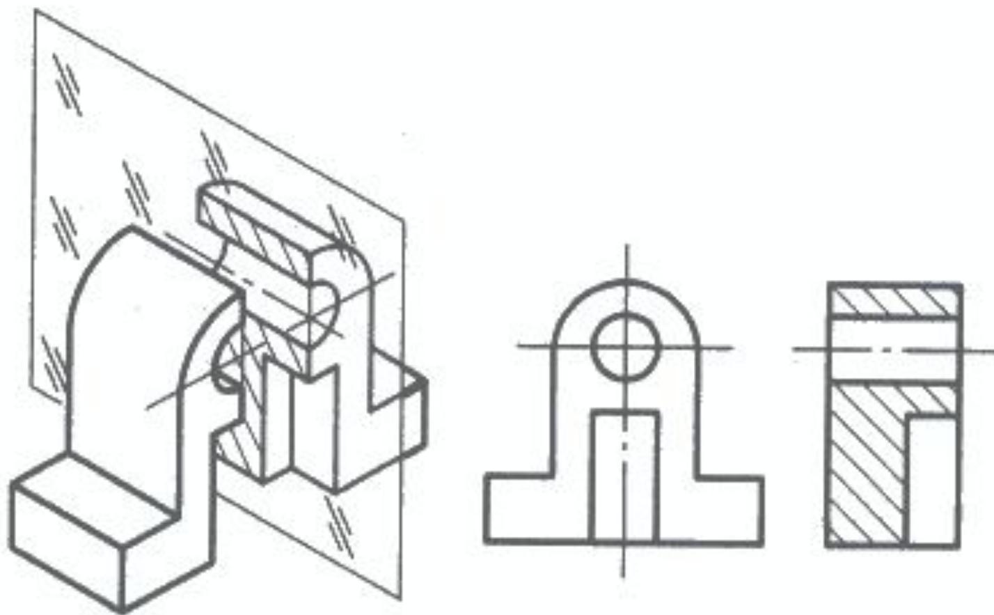
*Рис. 242.* Образование простого профильного разреза
