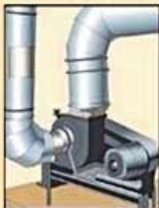
Общий вид вентилятора с электроприводом
