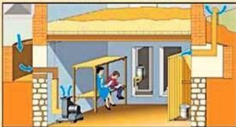
Подвал одноэтажного здания, приспособленный под противорадиационное укрытие
