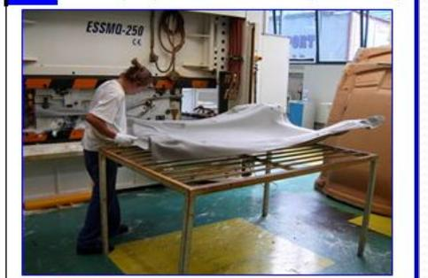
**5** Описание: переместите обивку в гидроструйный отсек, положите в отсек, чтобы отверстия для ГС отсека и направляющие штыри совпали, и нажмите кнопку на панели управления.
