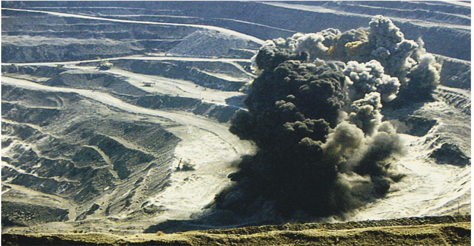
Породы включают частицы углерода и серный колчедан, он же пирит, при разложении которого происходит выделение теплоты. Это приводит к возгоранию обвалов. Они могут гореть, не затухая, несколько месяцев подряд. При сгорании выделяется множество вредных газов и химических соединений, тем самым сильно загрязняя атмосферу.
