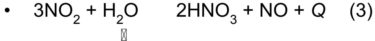
Это гетерогенный процесс в системе «Г-Ж». По сравнению со стадией диффузии NO<sub>2</sub> (полярный, кислый оксид) химическая реакция протекает быстро. Образующийся при этом оксид азота NO частично окисляется в растворе кислородом.
