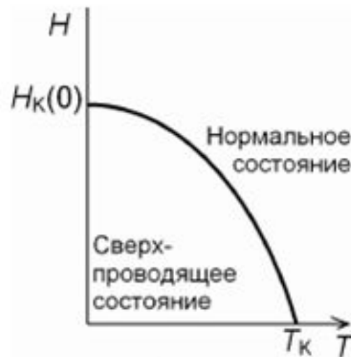
Рисунок 1. Зависимость критического магнитного поля H_k от температуры
