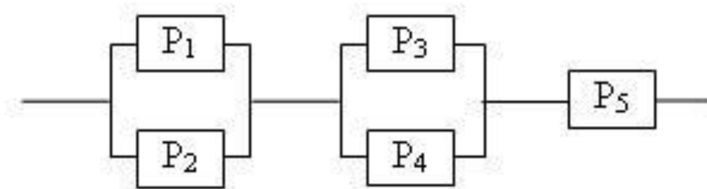
**Решение.** Разобьем цепь на **три** последовательно соединенных блока. И вычислим надежность каждого блока отдельно. **Первый блок** пропускает электрический ток в трех случаях: если исправен первый элемент и неисправен второй; если исправен второй элемент и неисправен первый; и если оба элемента исправны. Таким образом, надежность этого блока может быть представлена суммой:
