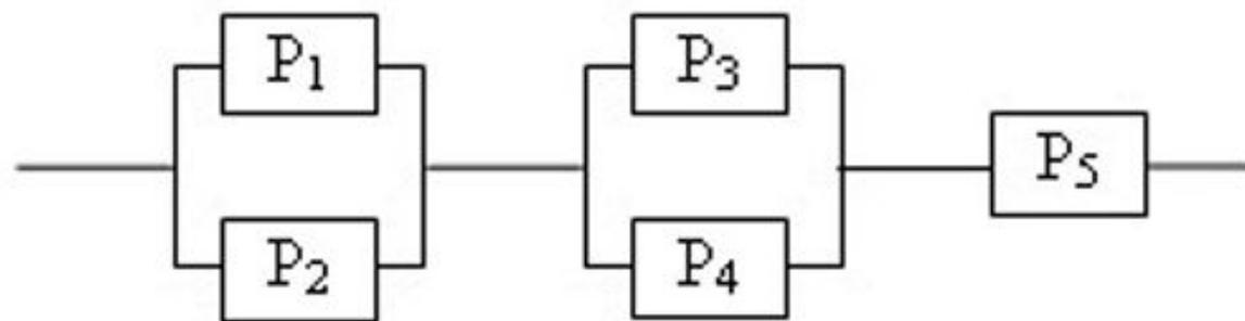
Теперь, зная надежности трех последовательно соединенных блоков, вычислим надежность цепи в целом. Схема пропускает ток только если все три блока исправны, то есть надежность схемы:
