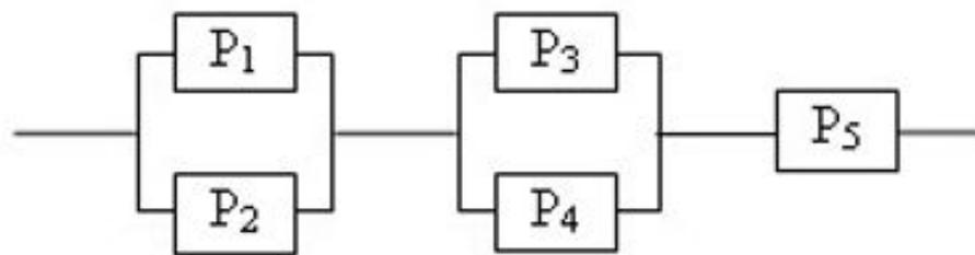
Однако проще надежность этого элемента вычислить через вероятность противоположного события. Вычислим вероятность того, что блок не пропускает ток и надежность найдем по формуле вероятности противоположного события. Блок не исправен только в случае когда и первый и второй элементы неисправны:
