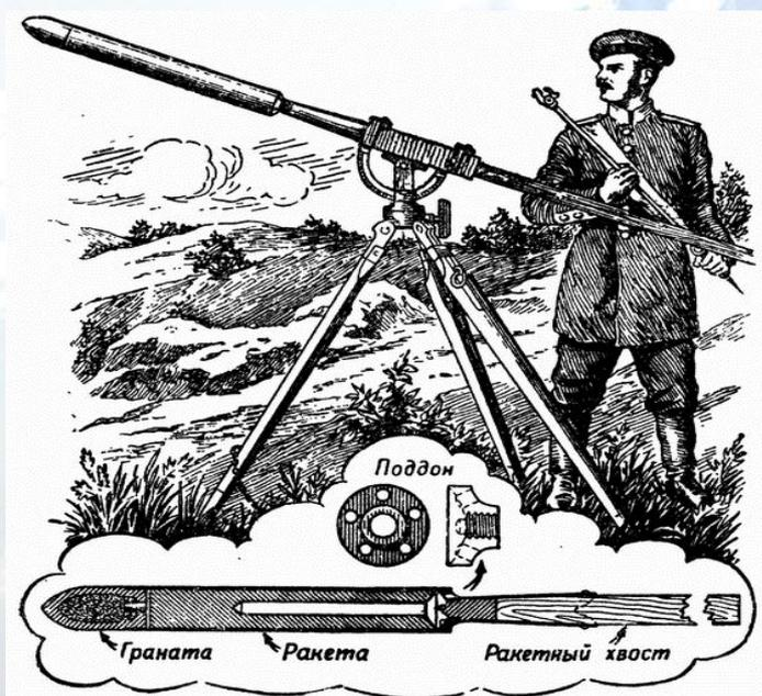
Рис. 24. Ракетный станок с боевой ракетой
