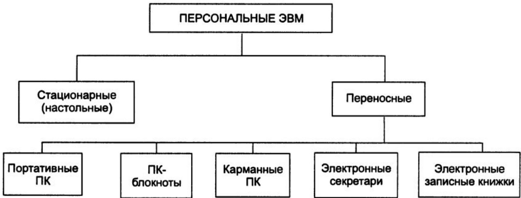
Рис. 4.7. Классификация ПК по конструктивным особенностям
