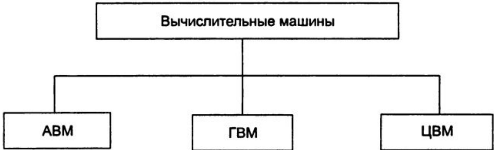
Рис. 4.1. Классификация вычислительных машин по принципу действия
