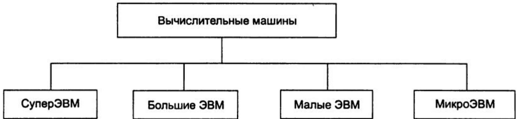
Рис. 4.4. Классификация компьютеров по размерам и вычислительной мощности
