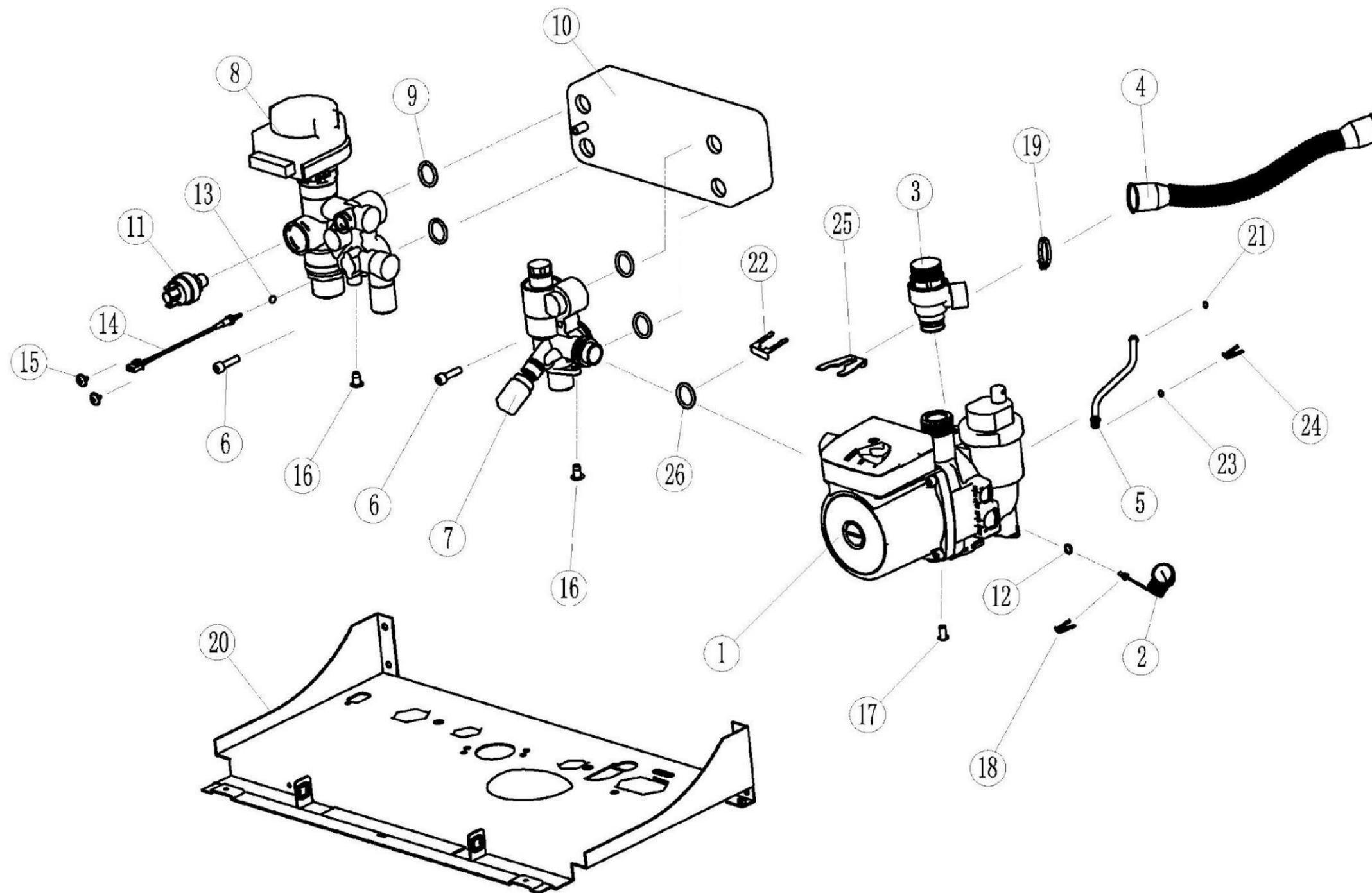
Схема взрыва водной системы : SATURN Combi-32K
