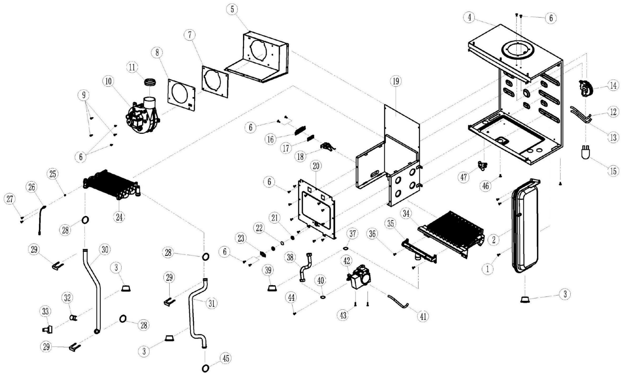
Схема взрыва коробки для сгорания : SATURN Combi-32K
