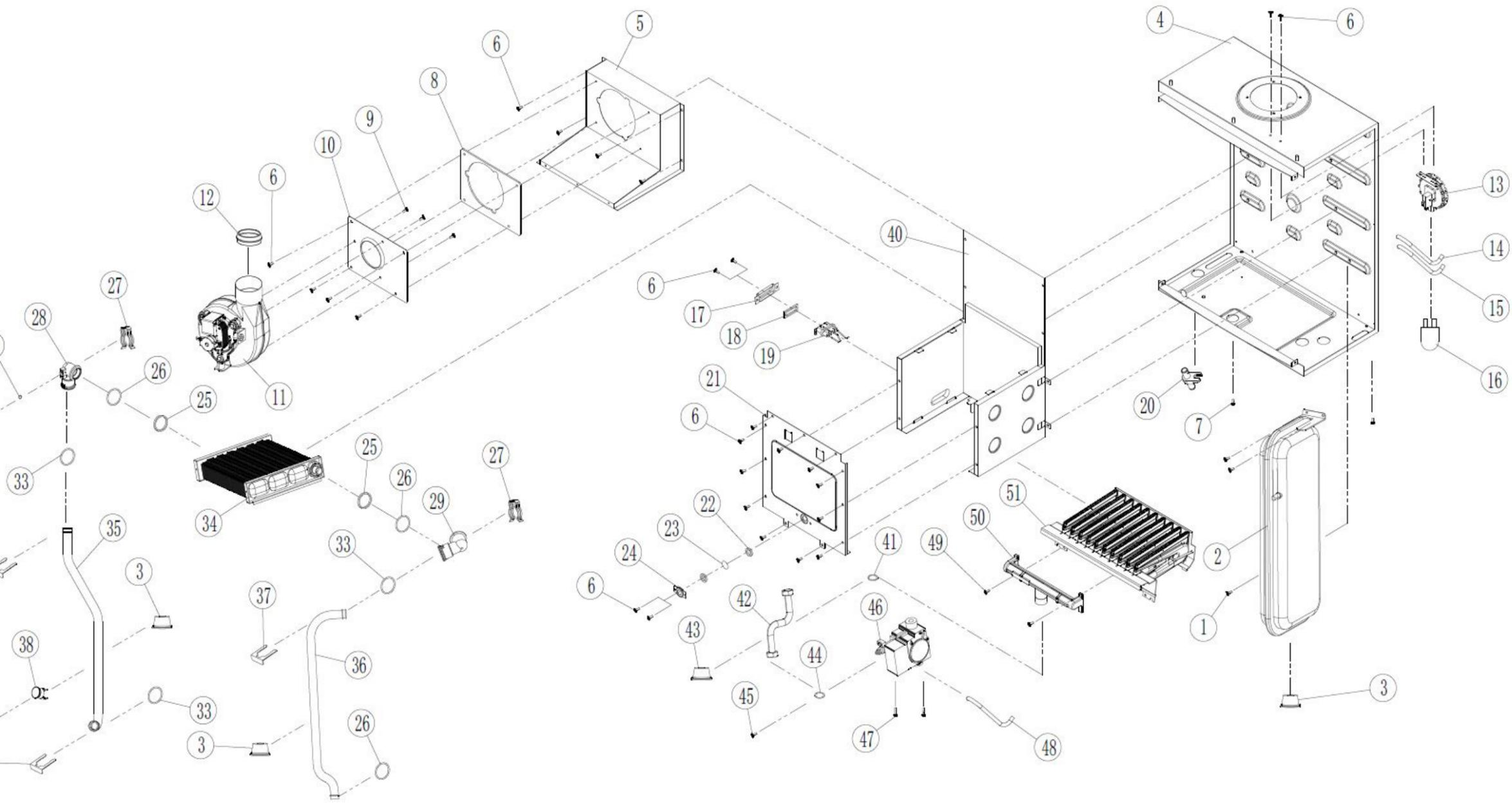
Схема взрыва коробки для сгорания : SATURN
