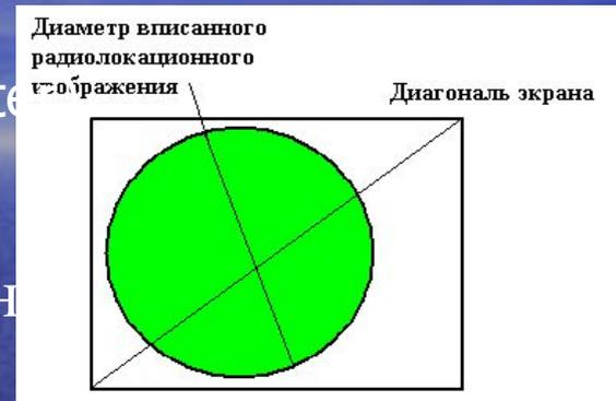
*Диаметр рисующего пятна resolution* - для монохромных индикаторов составляет 0,1 мм, для дисплеев характеризуется разрешением пикселя XGA, SVGA и др. Dot Pitch – межпиксельное расстояние. Диаметр рисующего пятна зависит от яркости, фокусировки, расстояния от центра экрана.
