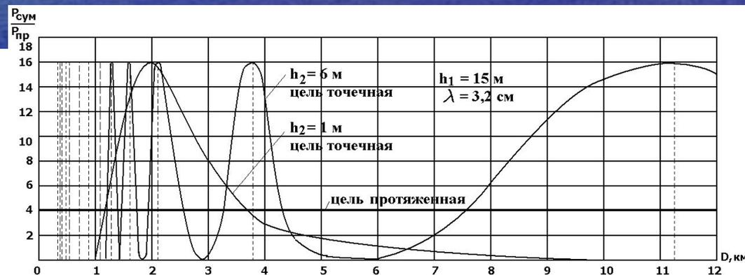
Функция имеет сложный характер, объясняется многолепестковой диаграммой направленности антенны в вертикальной плоскости. На некоторых дистанциях до цели коэффициент усиления мощности изменяется от 0 до 16 и более раз.
