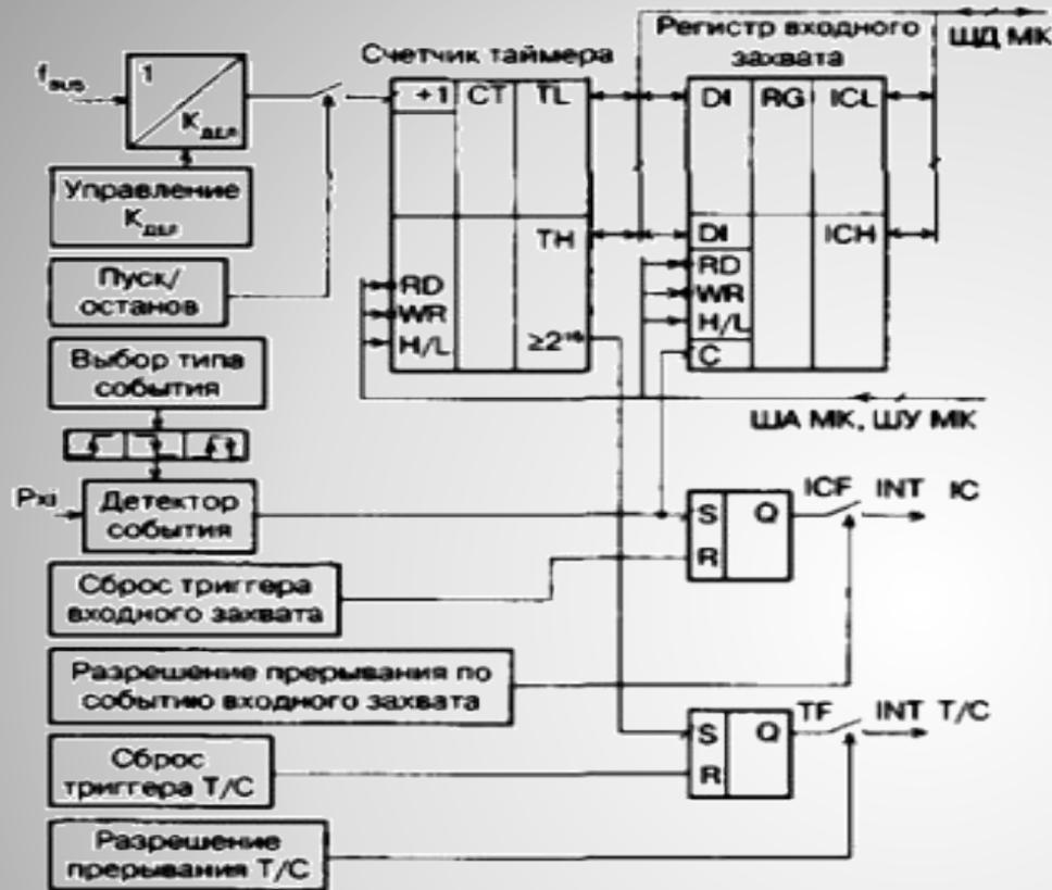
Структурная схема канала входного захвата таймера
