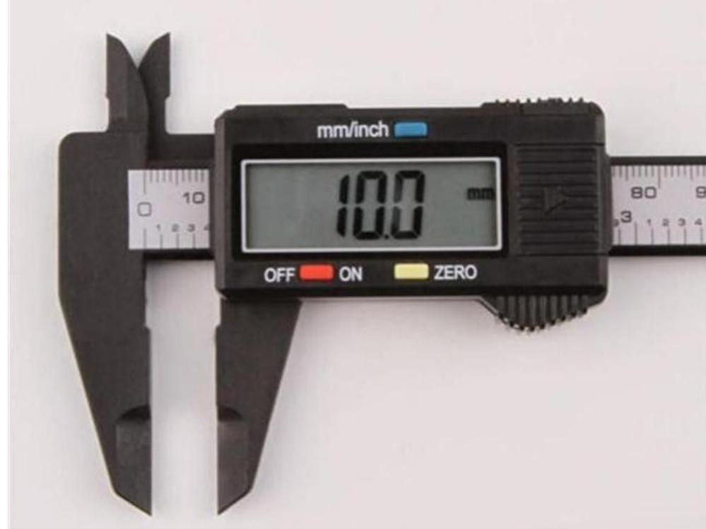
Штангенциркуль - незаменимый прибор в машиностроении и конструировании. С его помощью контролируют точность изготовления деталей.
