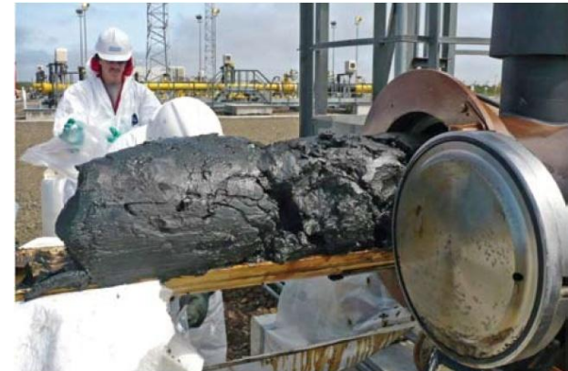
Часть парафиновых отложений из камеры приема скребка
