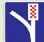
6.5 ПОЛОСА ДЛЯ АВАРИЙНОЙ ОСТАНОВКИ
