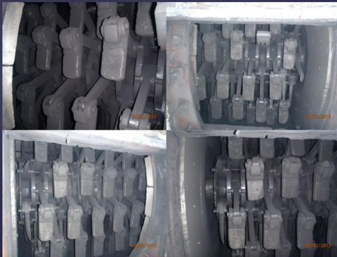
Металлические детали деформируются, частично ломаются и даже полностью разрушаются, если их поверхности не защищены от воздействия ударного износа. Ударный износ имеет место в дробильном и размольном оборудовании, где дробятся горные породы или гравий. При этом образуются мелкие абразивные частицы, поэтому поверхности оборудования требуется одновременно защищать и от абразивного износа.
