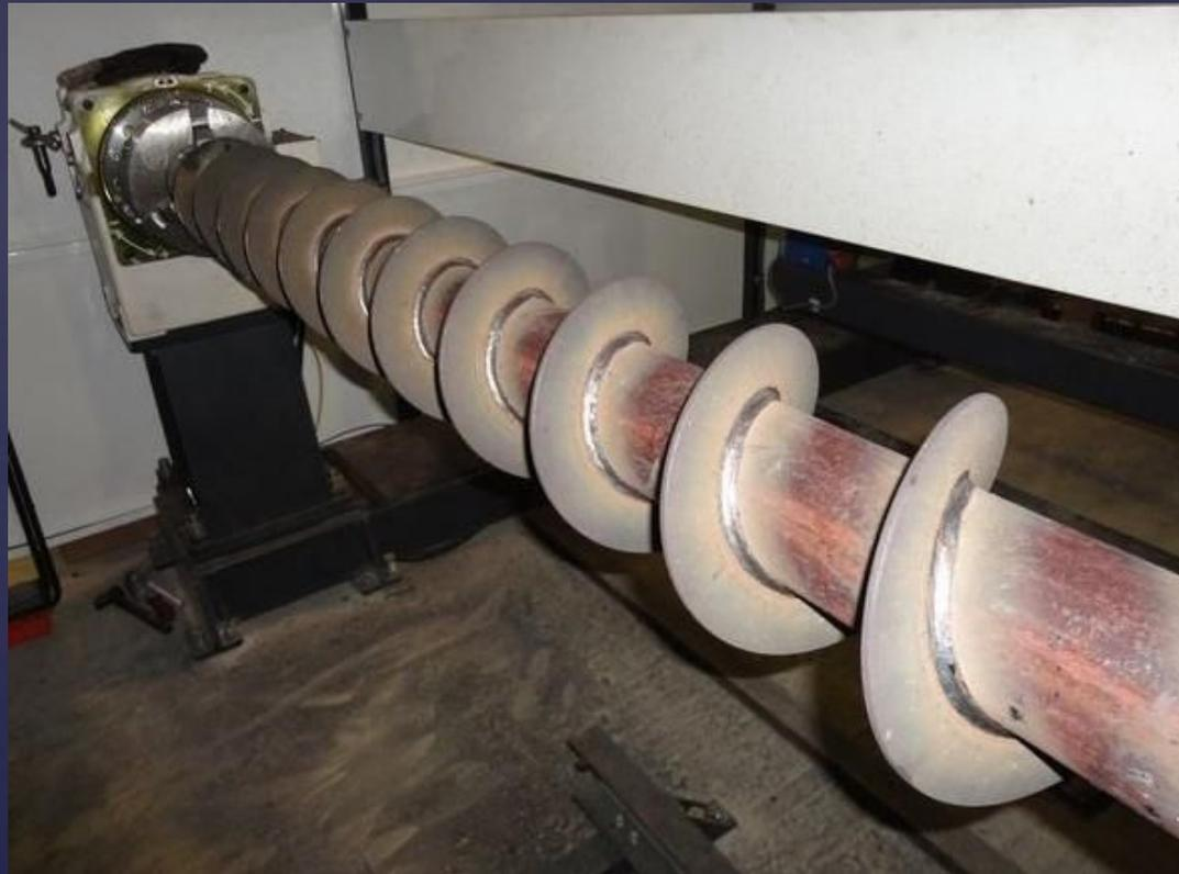
Этот тип износа возникает при скольжении острых частиц по металлической поверхности с различной скоростью. Износ происходит посредством стачивания металла частицами, которые подобны маленьким режущим инструментам. Чем тяжелее частица и более острая у нее форма, тем серьезнее истирание.
