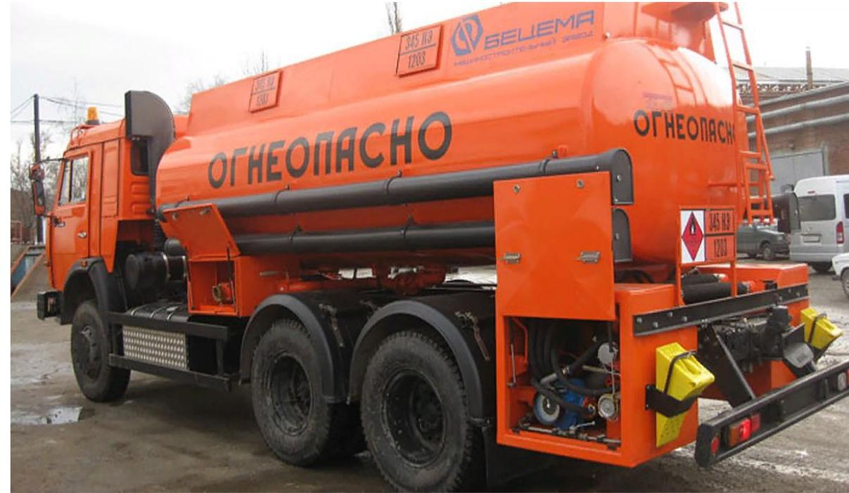
Автоцистерна СУГ представляет собой резервуар для сжиженного газа, установленный на шасси отечественного или импортного производства. Полуприцеп цистерна - это резервуар СУГ установленный на подкатную тележку с помощью седельно-сцепного устройства.
