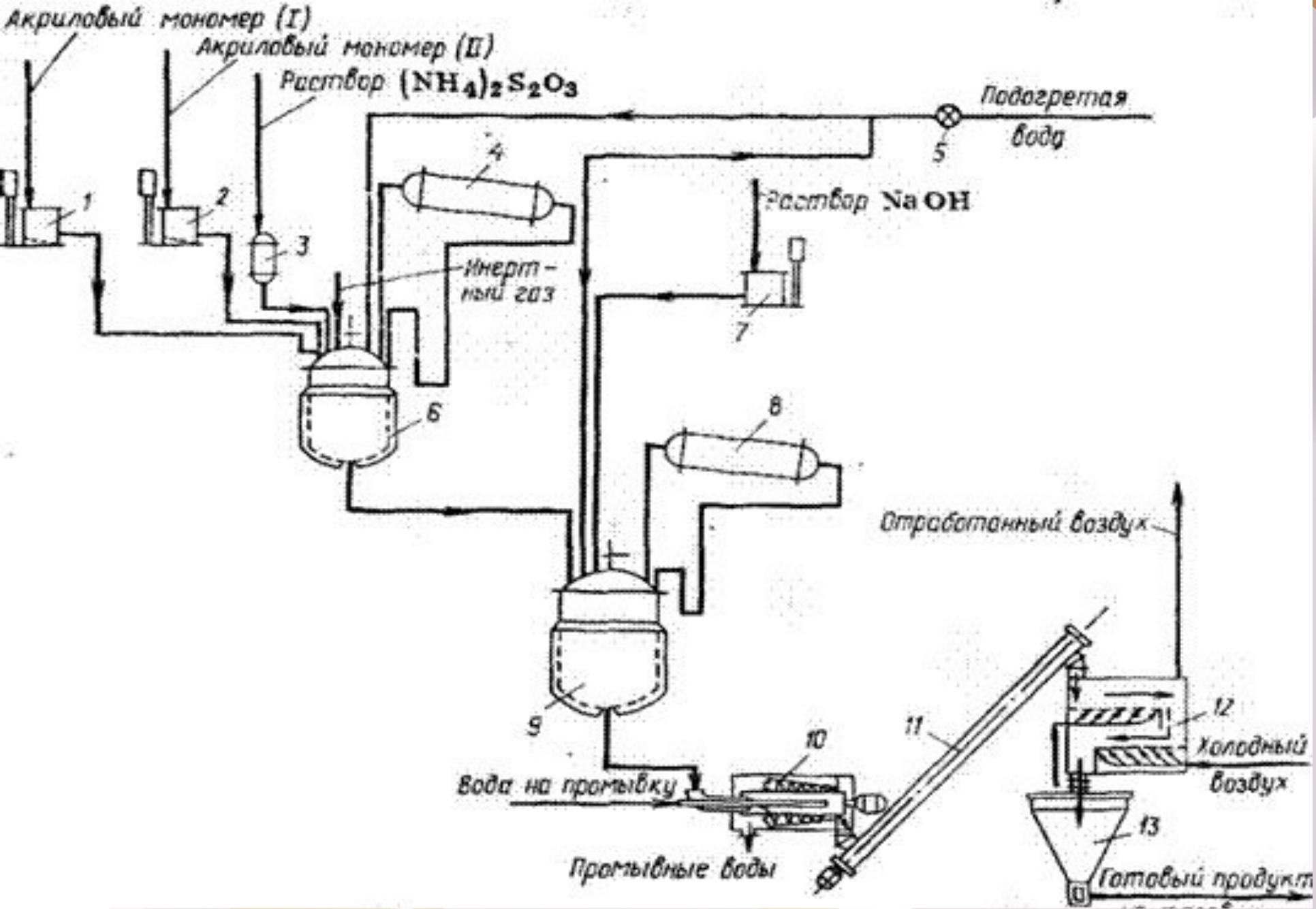
В реакторе 6, снабженном пароводяной рубашкой, готовят водную фазу, состоящую из воды, нагретой до 50 °С, и эмульгатора, и при интенсивном перемешивании загружают смесь мономеров, очищенных от ингибитора, и предварительно приготовленный раствор водорастворимого инициатора (на-
