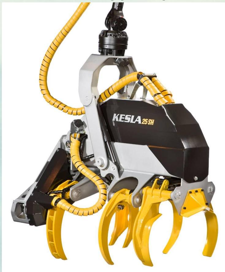
Валку дерева харвестер начинает с подведения харвестерной головки к стволу и захвата дерева. Средние деревья харвестер валит одним сплошным пропилом, а на крупных сначала совершает встречный пропил.
