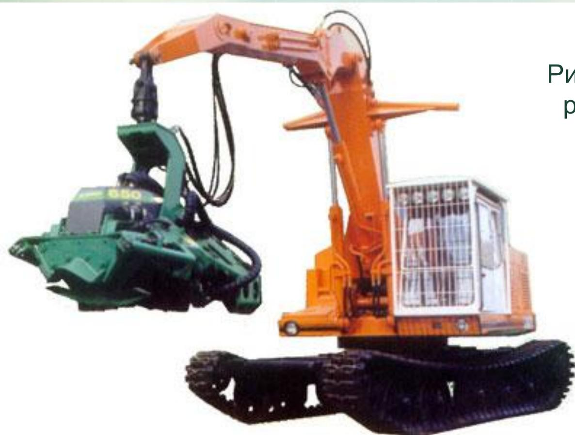
Рис. 4.42. Валочно-сучкорезно-раскряжевочная машина (харвестер) МЛ-152
