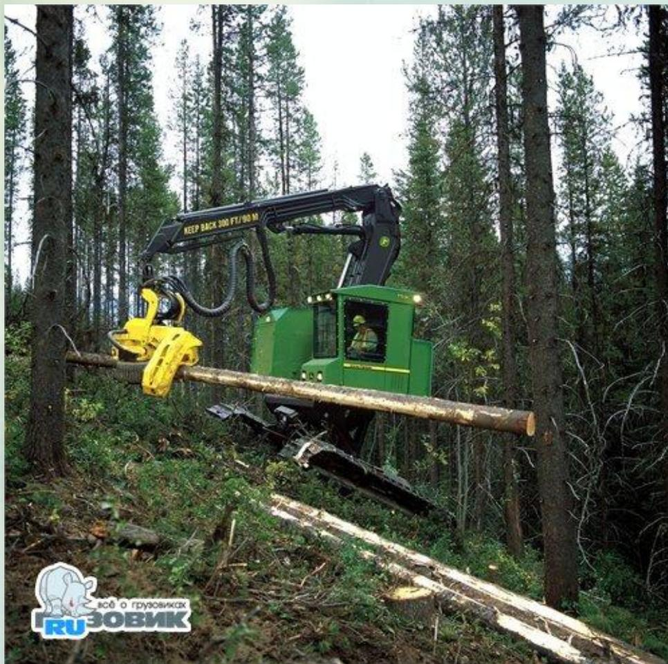
Рис. 4.50. Харвестер на базе экскаватора John Deere 759G
