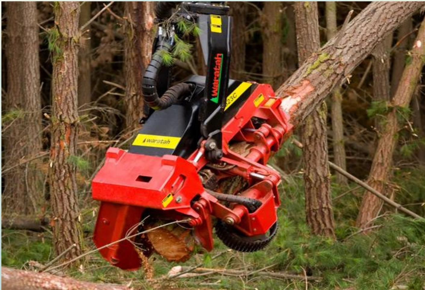
Управляется харвестер опытным оператором, который умеет использовать кинетическую энергию падающего дерева и начинает протаскивание ствола для обрезки сучьев и раскряжевки уже во время падения дерева.
