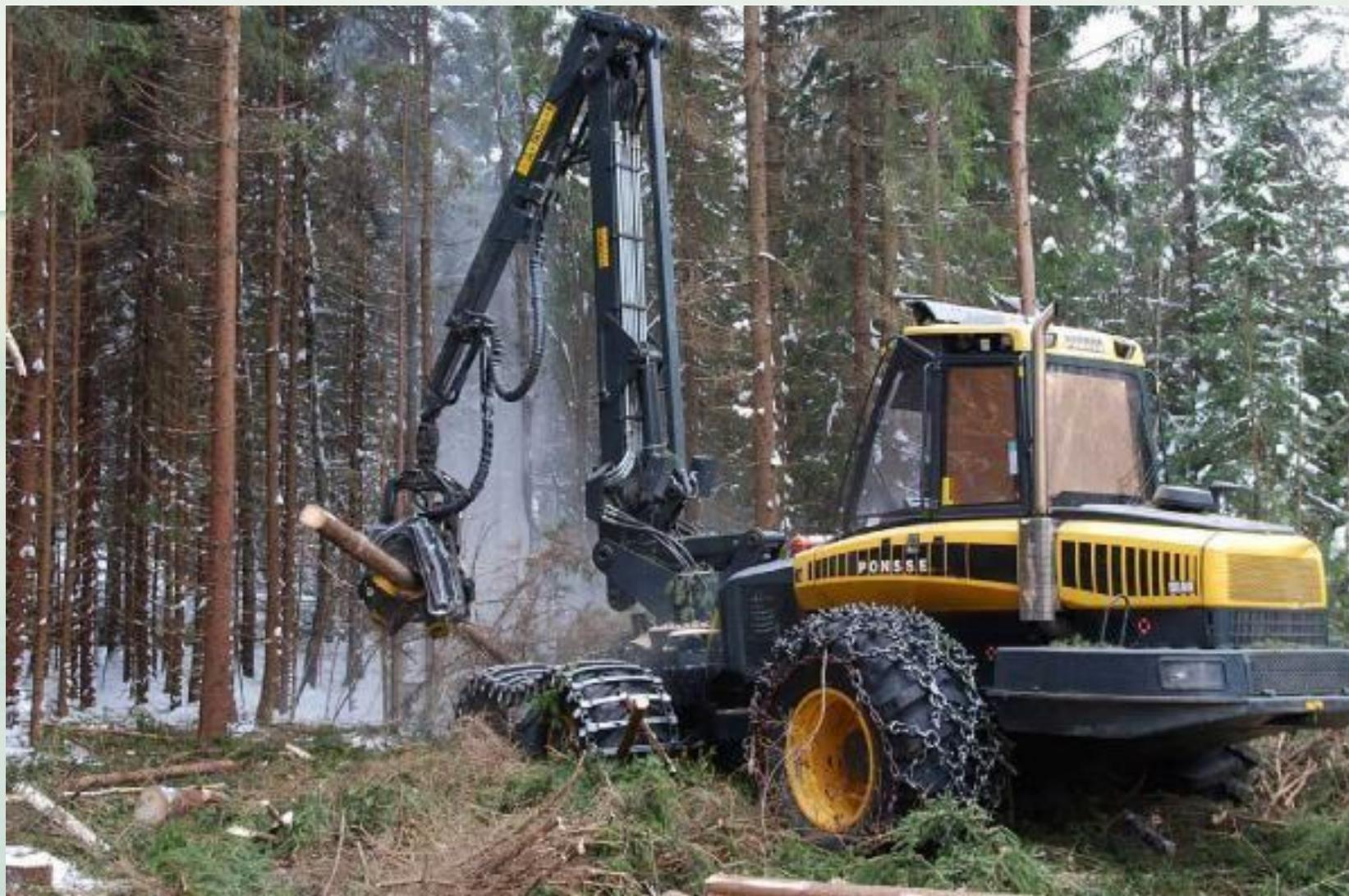
Рис. 4.48. Одномодульный харвестер Ponsse Ergo
