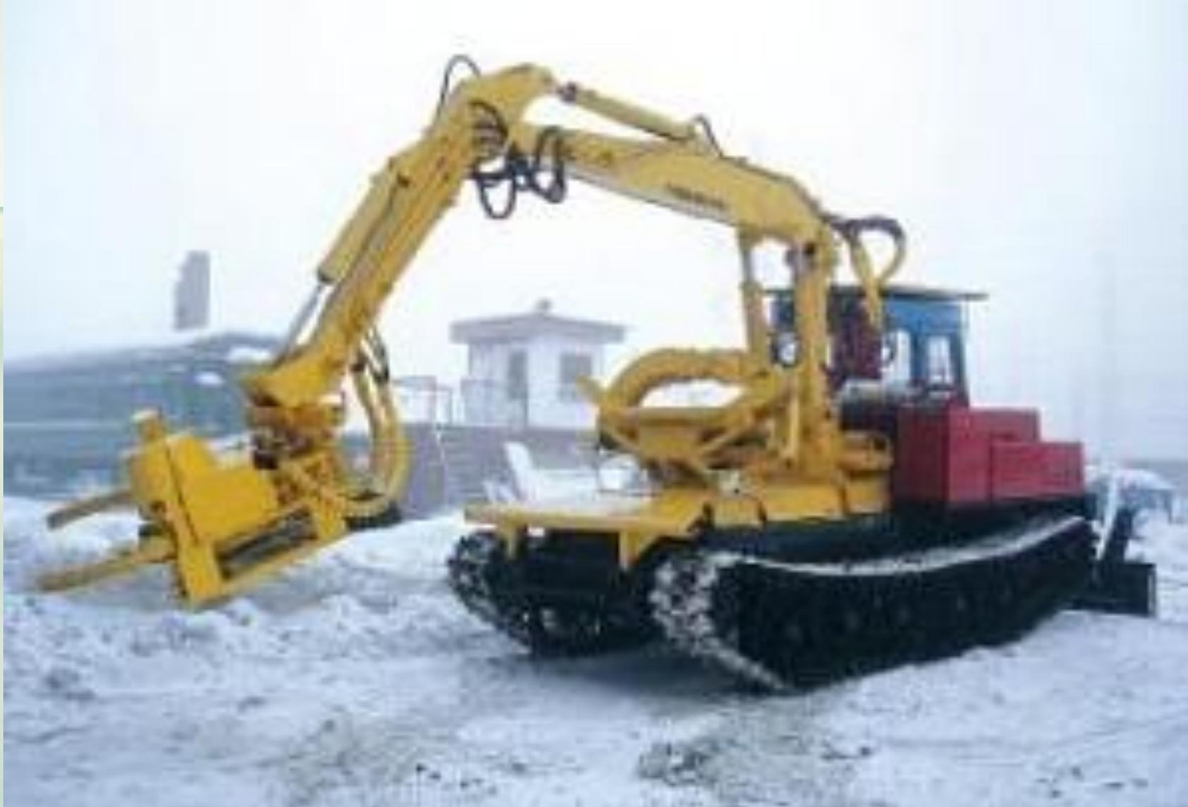
Рис. 4.31. Валочно-трелевочная машина ЛЗ-235
