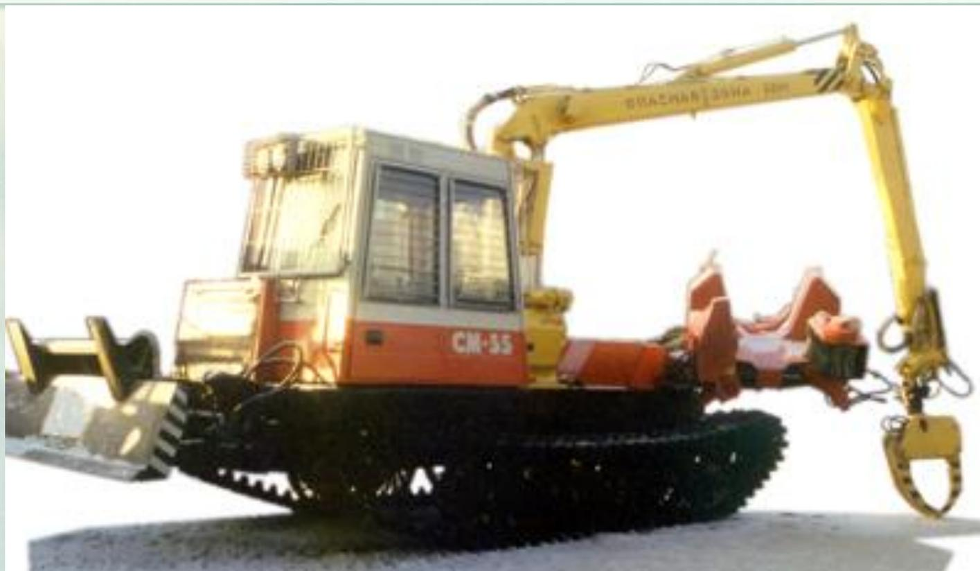
Рис. 4.46. Сучкорезно-раскряжевочная машина СМ-35
