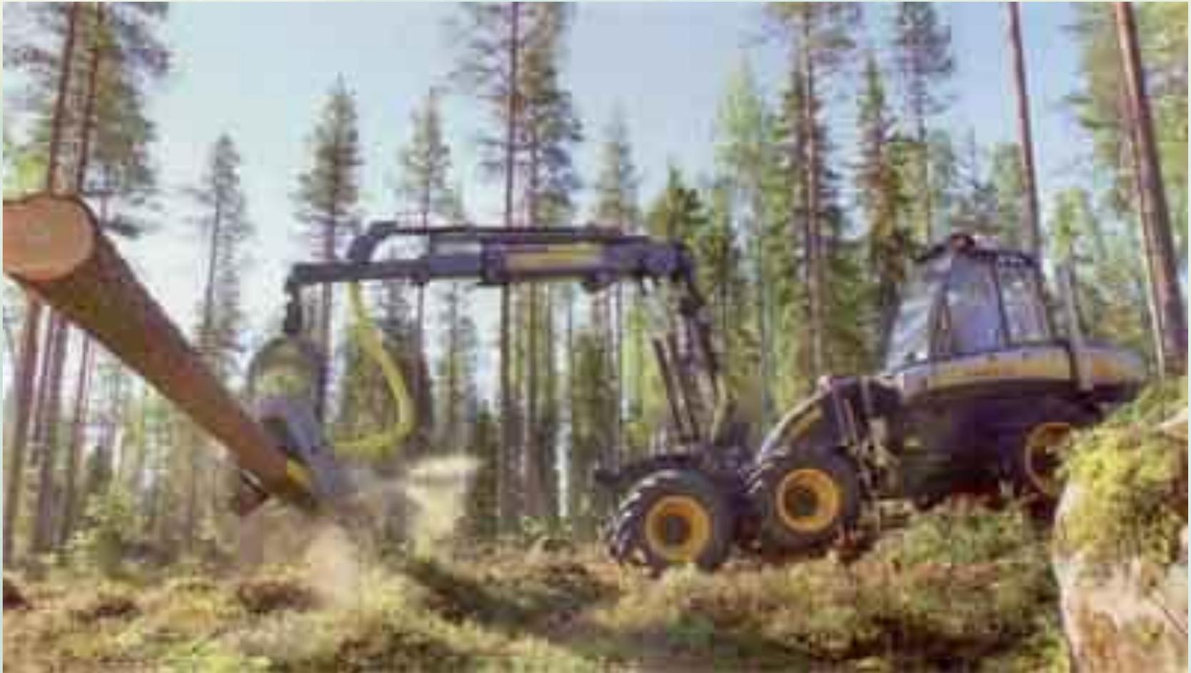
Для разделки ствола на сортименты любой современный харвестер имеет измерительную автоматику, которая предлагает оператору оптимальную раскряжевку. Ствол перерезается сверху на бревна сплошными пропилами, создающими опасность появления сколов и трещин в нижней части ствола. Поэтому обрабатываемое дерево следует частично опирать об землю или наклонять стрелу манипулятора вниз при завершении разделки.
