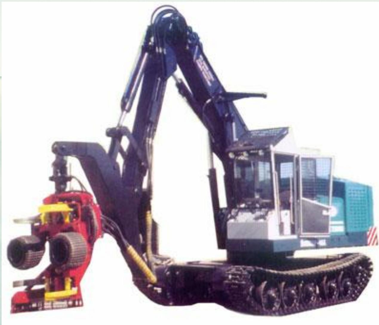
Рис. 4.44. Валочно-пакетрующая машина ЛП-19А (харвестер) с харвестерной головкой SP-650
