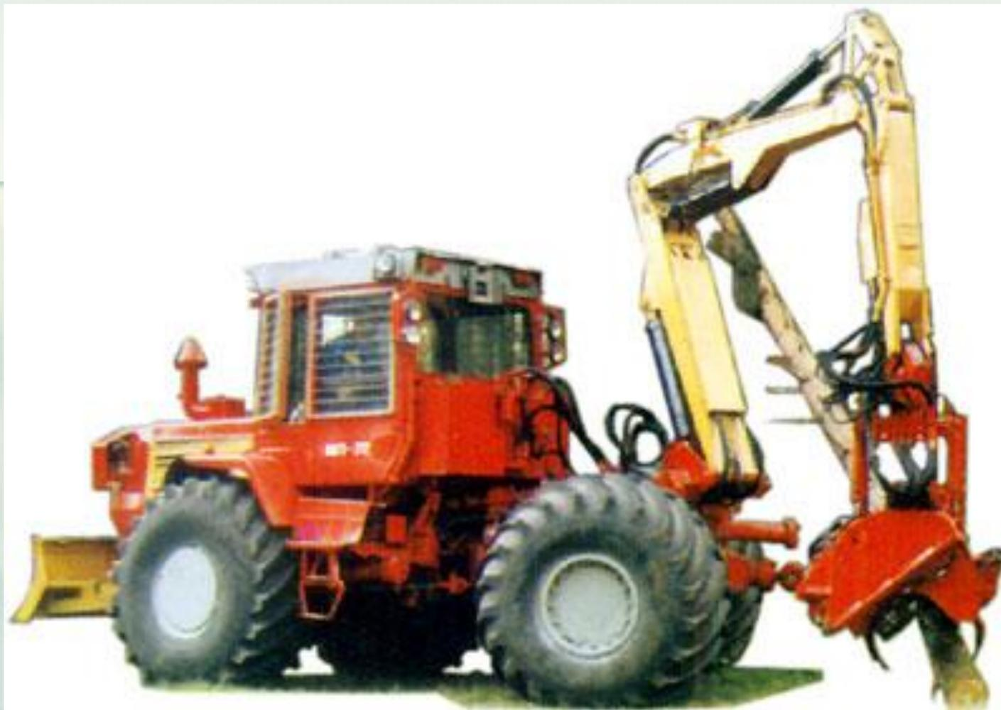
Рис. 4.45. Валочно-сучкорезно-раскряжевочная машина (харвестер) МЛ-72
