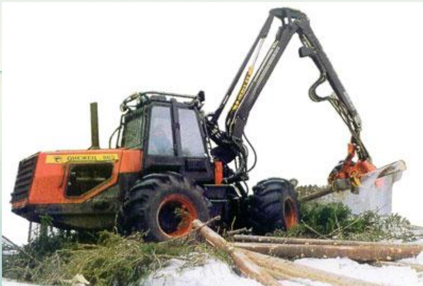
Рис. 4.43. Валочно-сучкорезно-раскряжевочную машину ТЛК4-15
