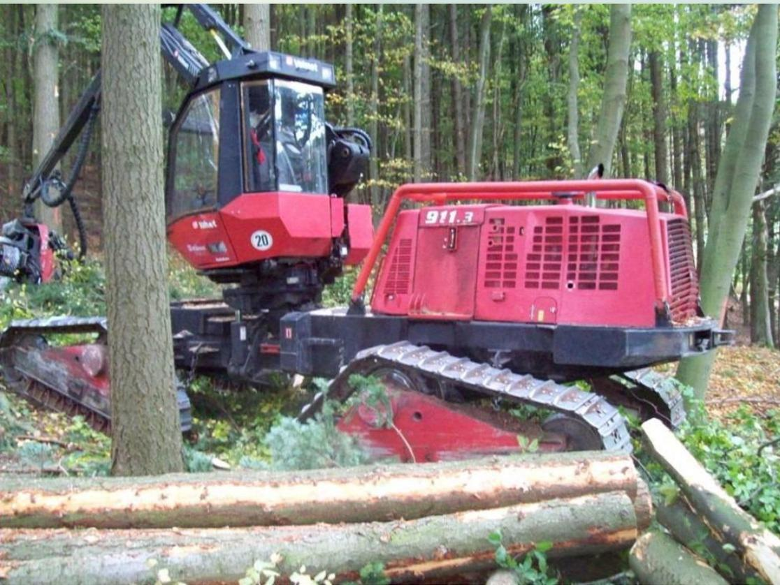
Рис 4.51. Гусеничный харвестер специального назначения Valmet 911.3 X3M
