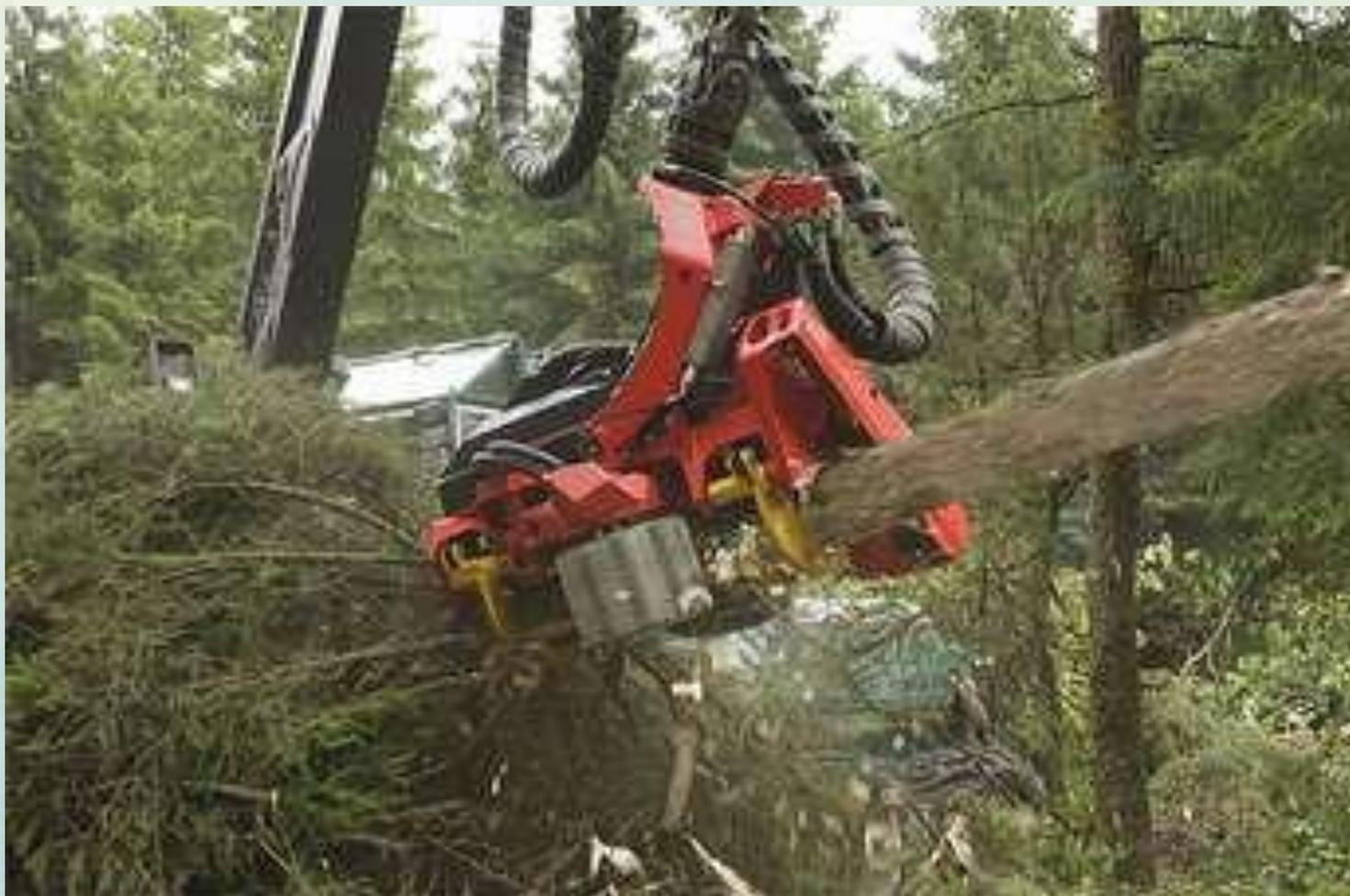
Одновременно манипулятор поворачивают в сторону окончательного места раскряжевки и укладки сортиментов.
