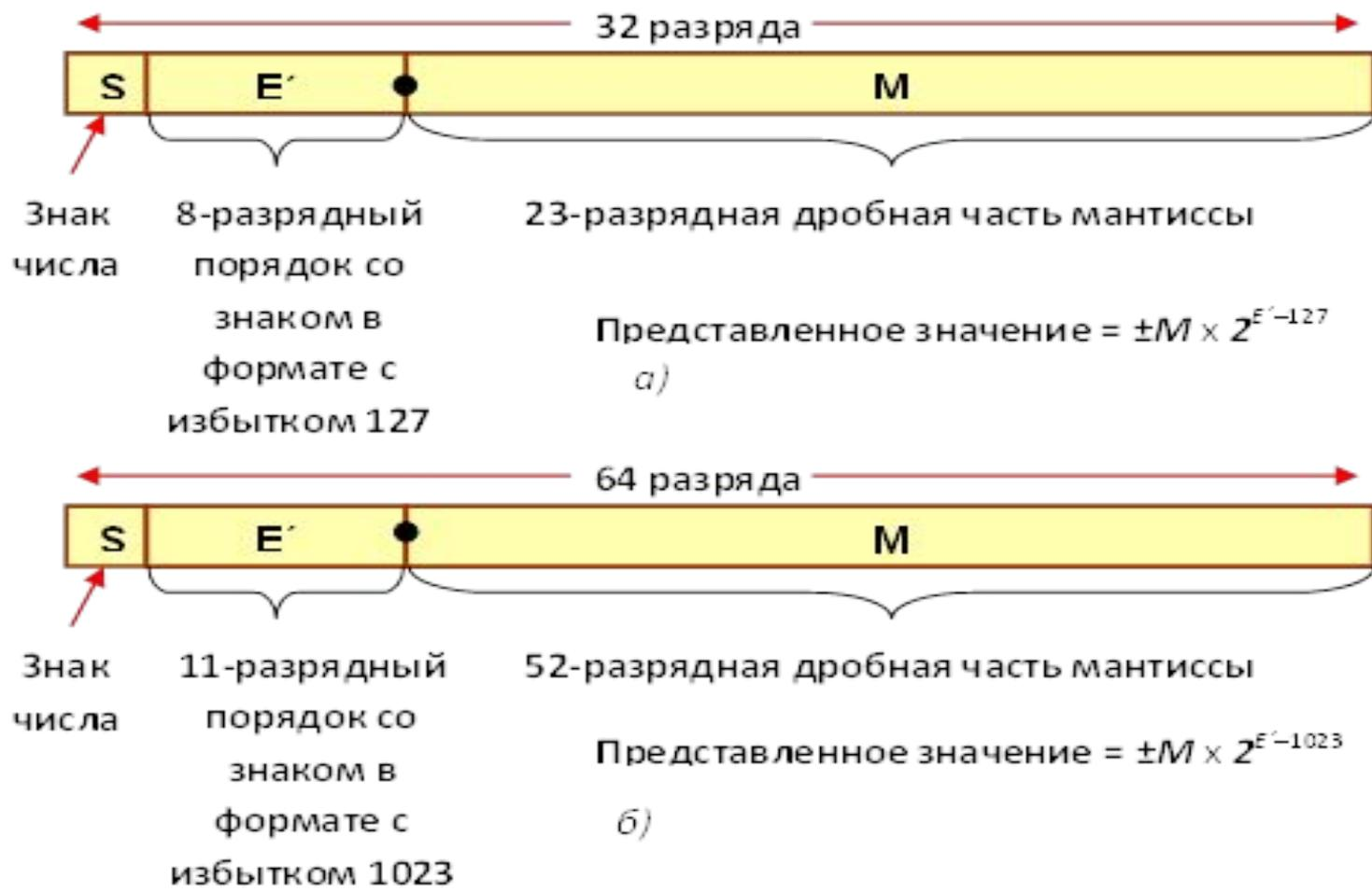
Рис.5 Представление чисел с плавающей точкой в соответствии со стандартом IEEE 754: а) с одинарной точностью; б) с двойной точностью.
