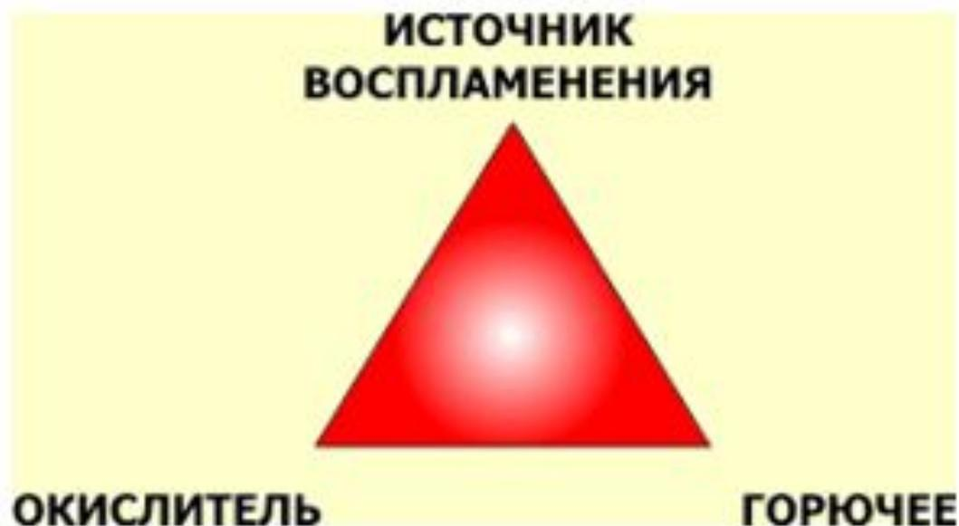
Рис.1 Классический треугольник пожара
