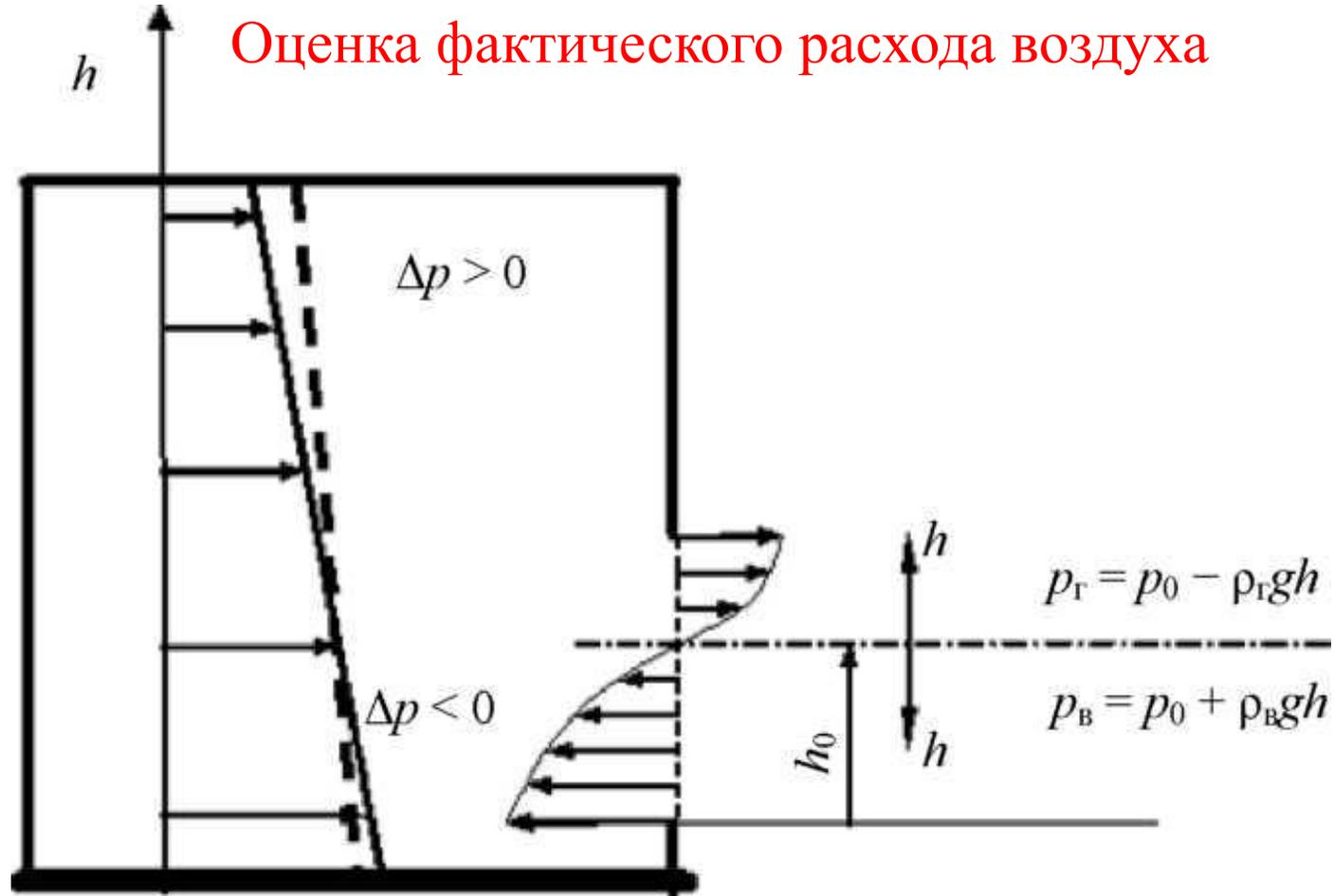
Рис. 3. Схема распределения давлений и газовых потоков при пожаре в помещении: стрелками показано направление движения газовых потоков; сплошная линия - эпюра давлений воздуха снаружи; пунктирная линия - эпюра давлений газовой среды внутри помещения
